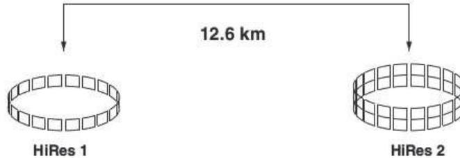
Figura 2.7: Esquema del experimento de fluorescente del proyecto HIRes, cada rectángulo representa un telescopio fluorescente que incluye un espejo y una cámara [14].
