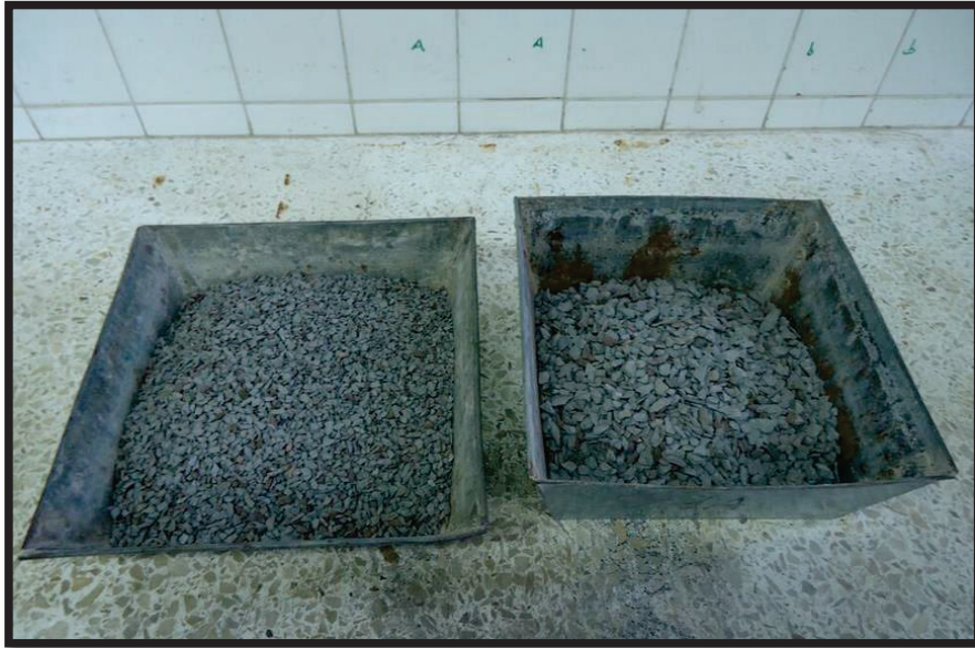
FOTOGRAFÍA 3. 14 MUESTRA PARA ABRASIÓN AGREGADO GRUESO, GRADACIÓN C.
