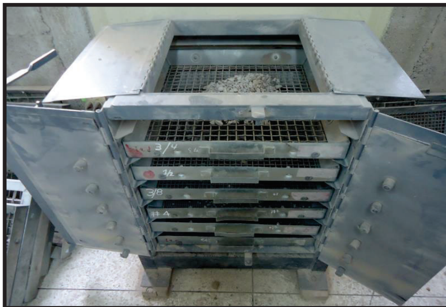
FOTOGRAFÍA 3. 9 GRANULOMETRÍA DE AGREGADO GRUESO TAMAÑO MÁXIMO NOMINAL 1/2"
