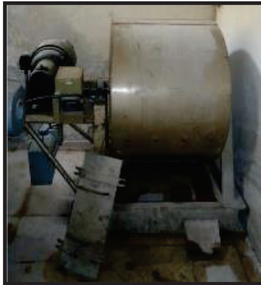
FOTOGRAFÍA 3. 15 ABRASIÓN - MAQUINA DE LOS ÁNGELES
