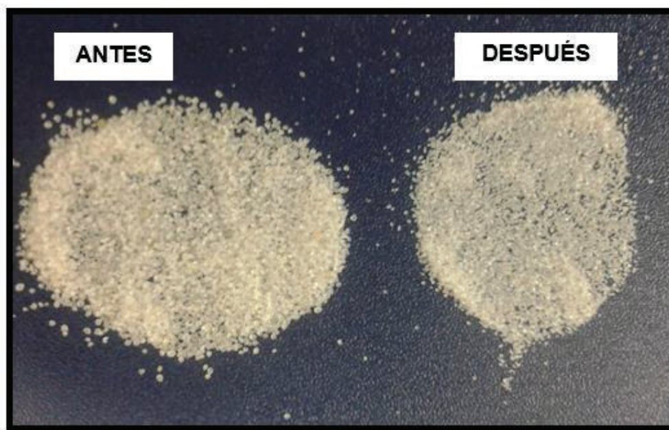
FOTOGRAFÍA 6. 1 PARTÍCULAS ABRASIVAS ANTES Y DESPUÉS DEL ENSAYO SANDBLASTING
