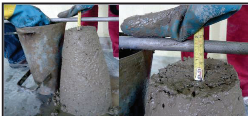
FOTOGRAFÍA 5. 2 ASENTAMIENTO DEL HORMIGÓN G1 SIN ADITIVO
