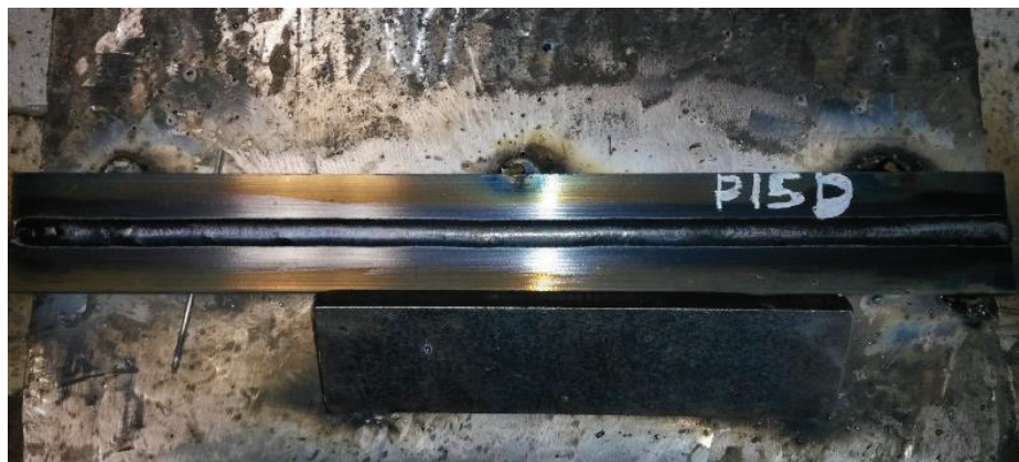
Figura 3.15 Soldaduras de depósitos terminados.
