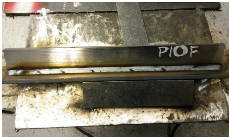
Figura 3.18 Probeta P10F, soldada con el proceso GMAW.
