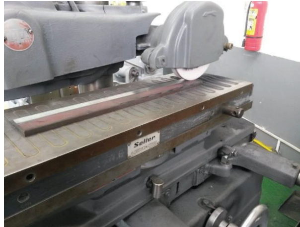
Figura 3.4 Rectificado de la superficie a soldar.
