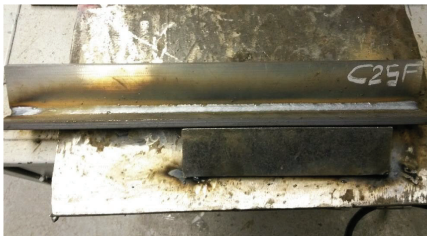
Figura 3.16 Probeta C25F, soldada con el proceso GMAW.
