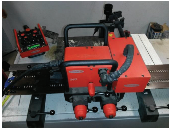
Figura 3.7 Equipo Flextrack 45, carro de soldadura.
