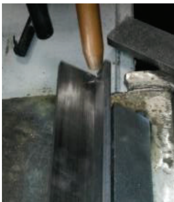
Figura 3.13 Orientación de la probeta y ángulo de la boquilla.
