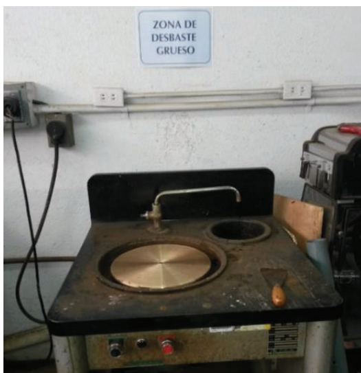
Figura 3.20 Equipo de desbaste grueso. Laboratorio de metalografía EPN.
