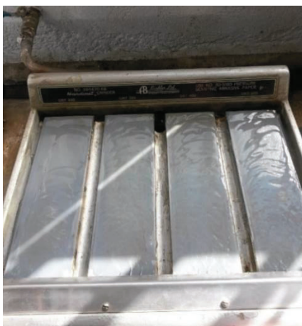
Figura 3.21 Banco de lijas para desbaste fino. Laboratorio de metalografía EPN.
