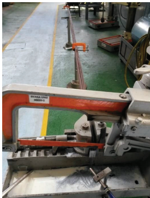
Figura 3.1 Corte de las platinas en la sierra alternativa.
