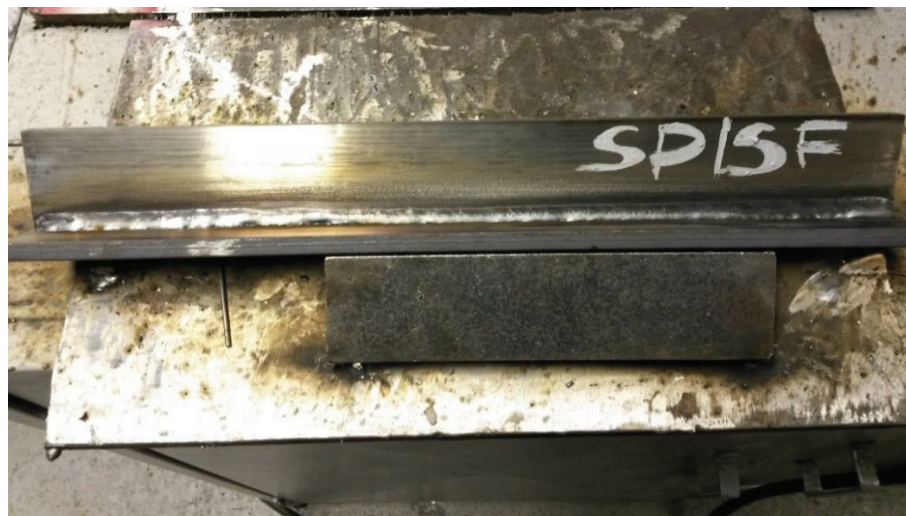
Figura 3.17 Probeta SP15F, soldada con el proceso GMAW.
