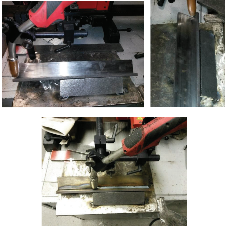
Figura 3.12 Posicionamiento de la probeta en posición 1F.
