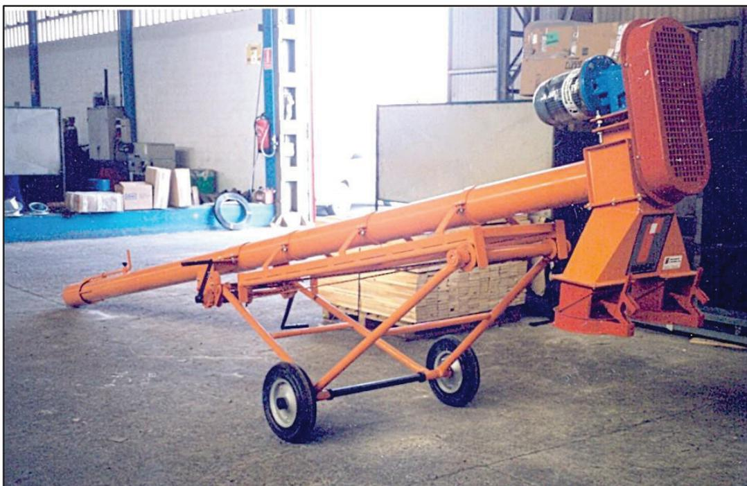
**Figura 3.24** Transportador de tornillo sugerido
