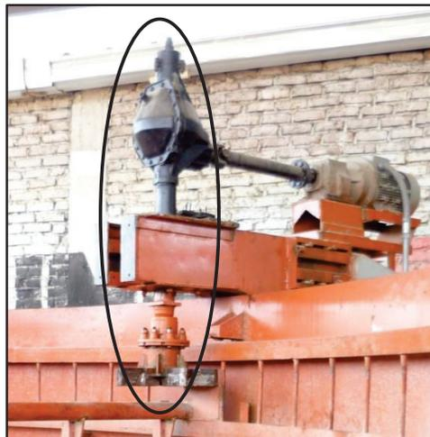
**Figura 2.28** Eje motriz acoplado al motorreductor durante la construcción del Proyecto
