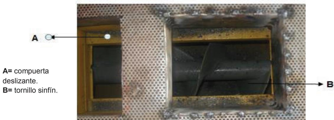
**Figura 3.20. Partes Principales Alternativa I: Sistema de descarga a través de compuerta.**
