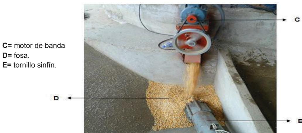
**Figura 3.21 Partes Principales Alternativa I: Sistema de descarga a través de compuerta.**
