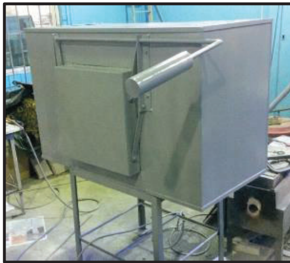
Figura 3.25. Horno con todos sus componentes instalados.
