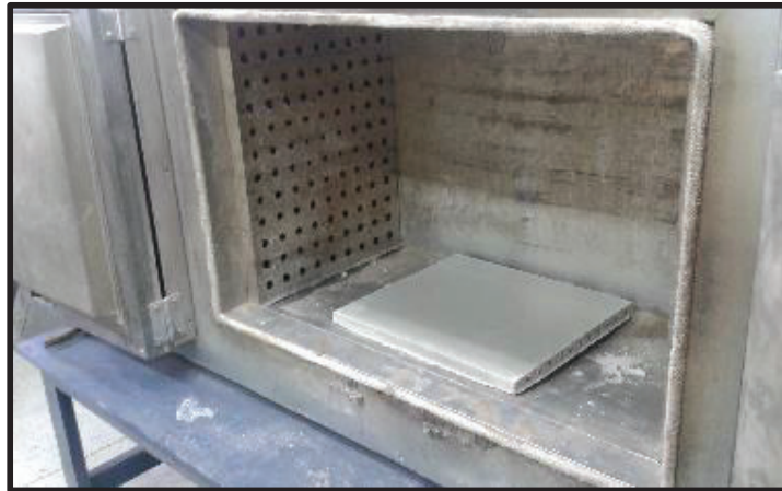
Figura 3.13. Secado de las placas porta-resistencias.
