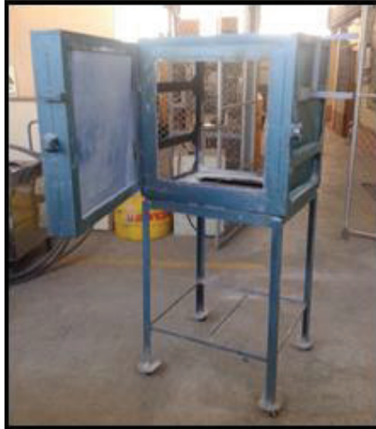
Figura 3.2. Estructura metálica de un horno en condiciones de desecho.
