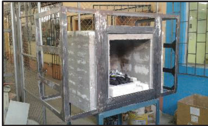
Figura 3.9. Paredes del ladrillo refractario
