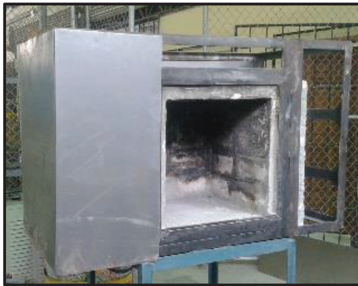
Figura 3.17. Montaje de la chapa metálica.
