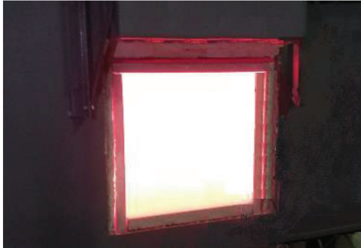
Figura 4.12. Interior de la cámara durante la prueba en vacío.
