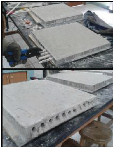
Figura 3.12. Desmoldeo de las placas porta-resistencias.
