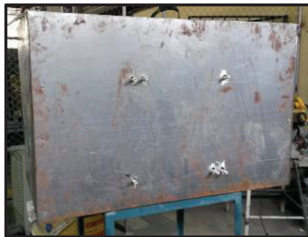
Figura 3.19. Ubicación de tubos cerámicos para los terminales de las conexiones eléctricas de las resistencias.
