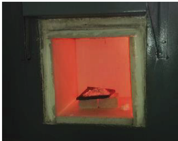
Figura 4.14. Recocido Acero AISI 1045
