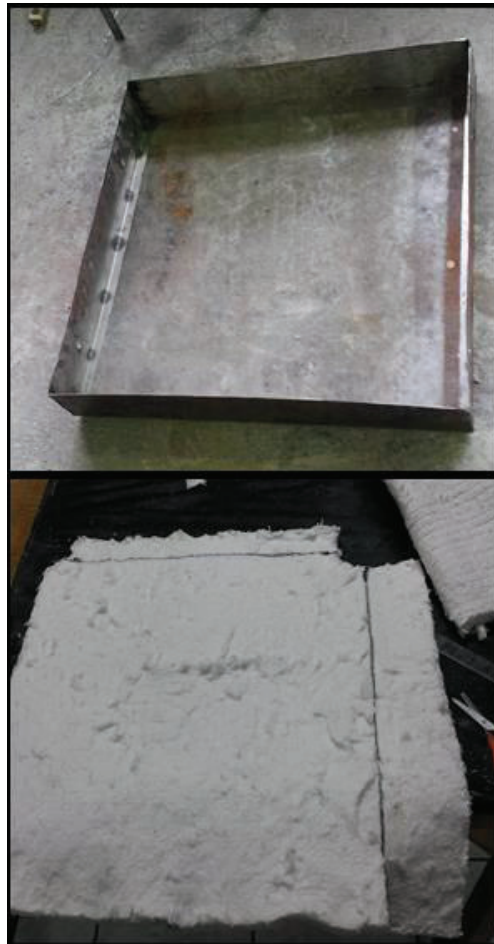
Figura 3.21. Diseño de la puerta y ubicación de la fibra cerámica.
