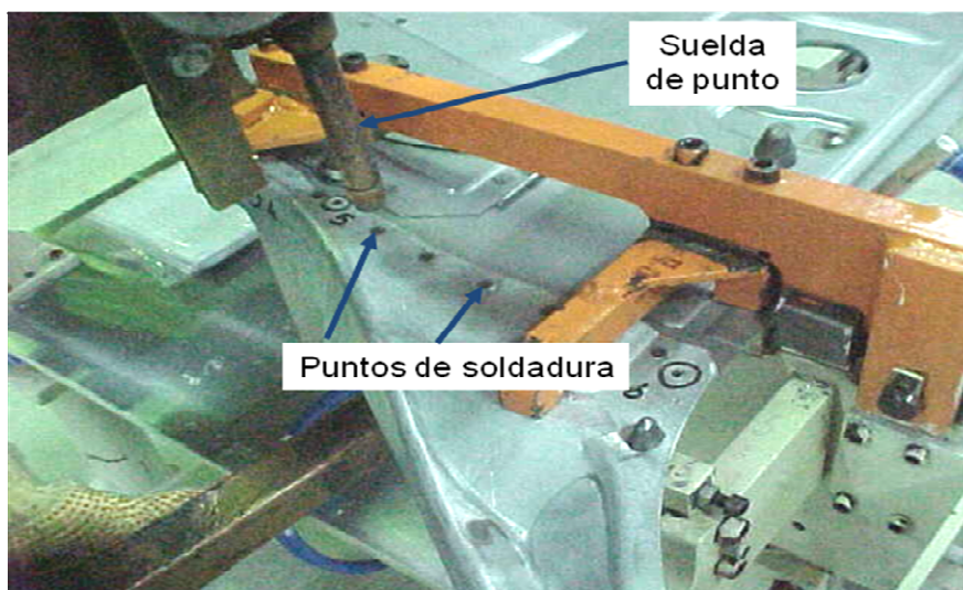
Fig. 3.5 Proceso de soldadura de todos los puntos
