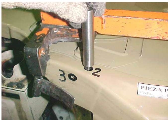
Fig. 2.10 Verificación de las perforaciones con el pasa – no pasa
