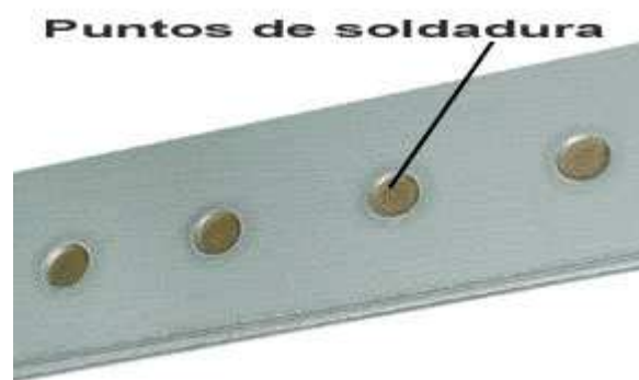
Fig. 2.7 Puntos de soldadura correctos
