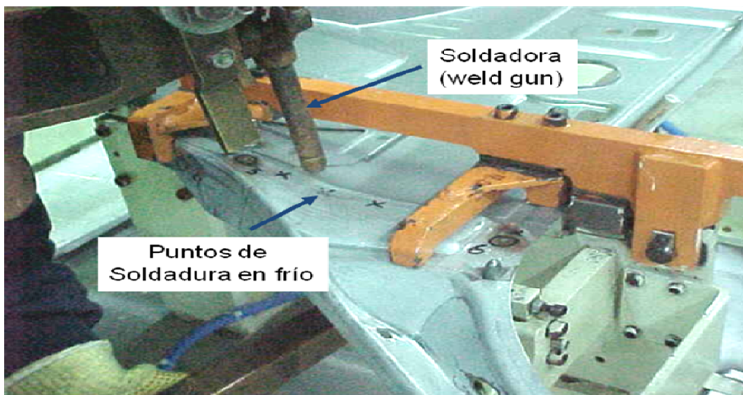
Fig. 2.13 Simulación del proceso de soldadura
