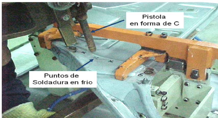
Fig. 3.4 Simulación del proceso de soldadura
