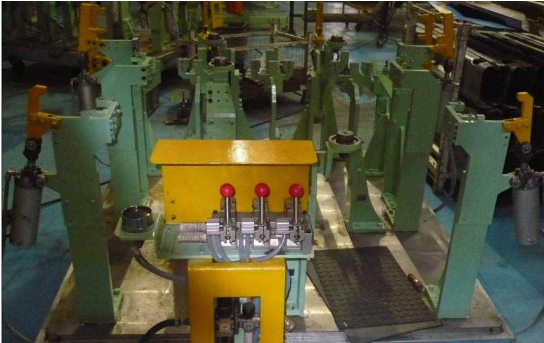
Fig. 2.1 JIG de ensamble de la primera estación
