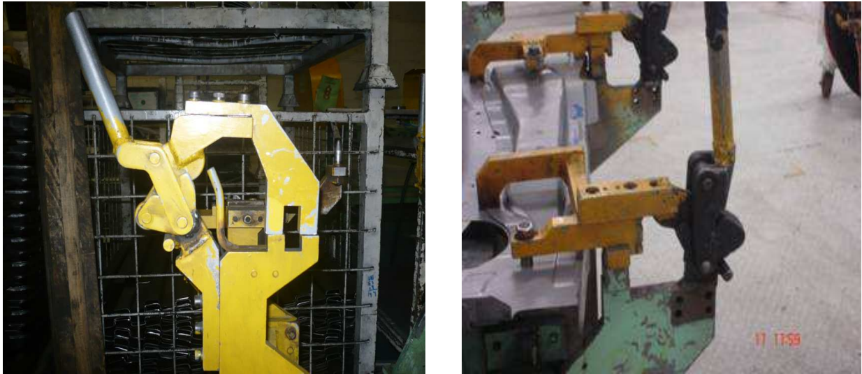
Fig. 2.5 Clamps para sujeción y posicionamiento
