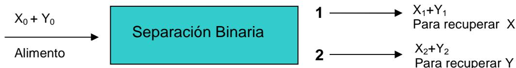
**Gráfico 7.32. Esquema de la definición para la separación binaria de materiales residuales**
