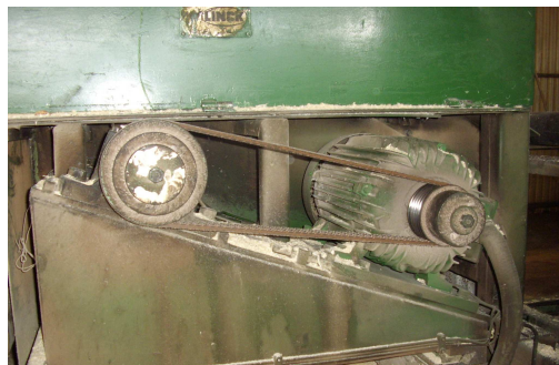
Figura 2.1 Motor para movimiento del disco de corte izquierdo máquina CB 15
