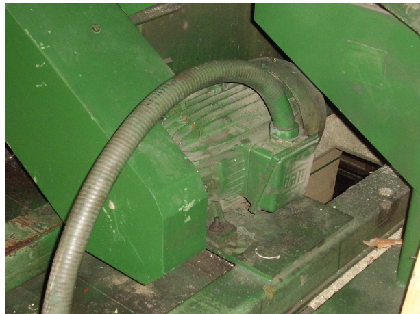
Figura 2.5 Motor para mover eje de los discos de corte
