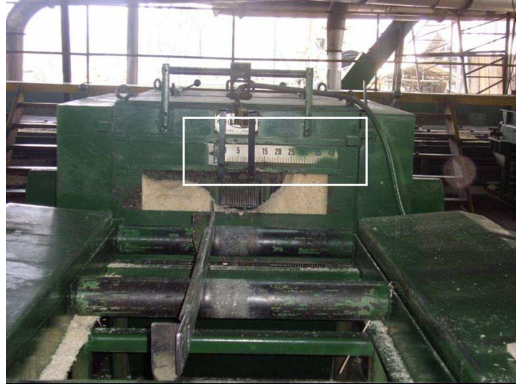
Figura 1.3.2 Regleta para visualizar valor de apertura - máquina CB 10
