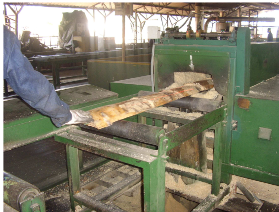
Figura 1.2.2 Ingreso de pedazos laterales en la máquina CB 15
