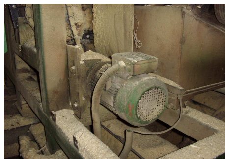
Figura 2.2 Motor reductor para mover cadena interna
