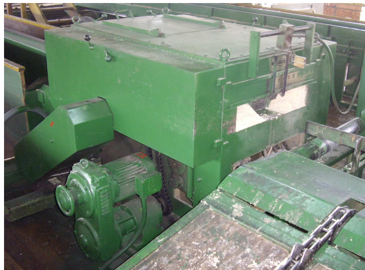
Figura 1.3.2 Sierra para corte de recuperación etapa 2 - máquina CB 10
