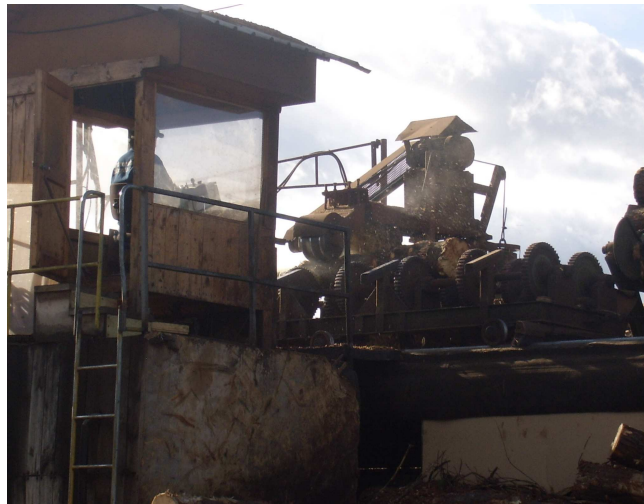
Figura 1.1.2 Descortezado de trozas
