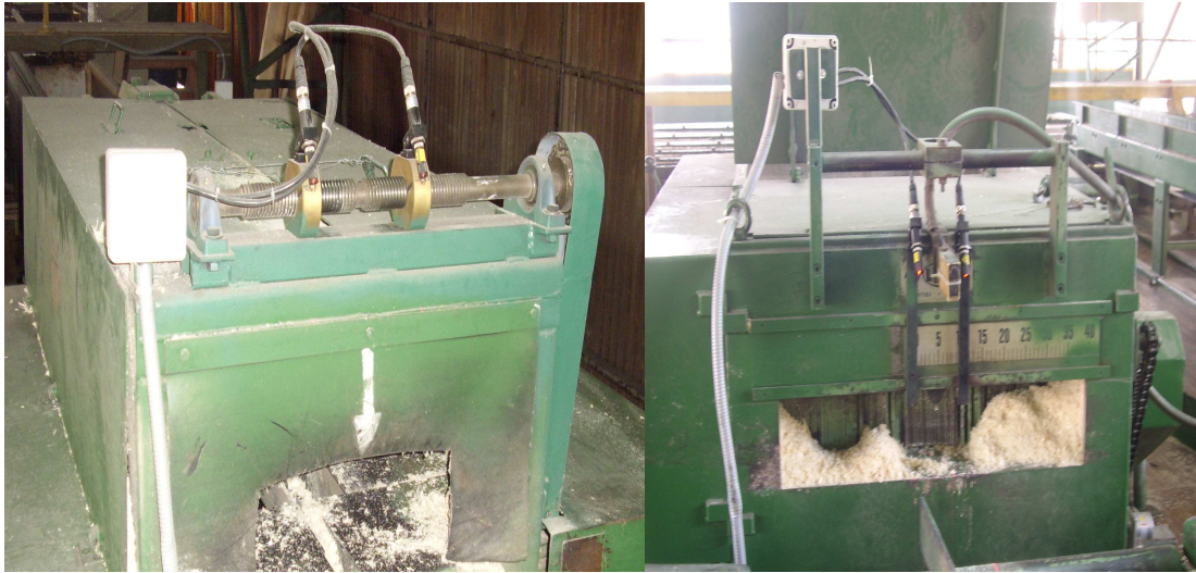
Figura 5.7 Guía visual de medida de corte máquina CB 15 y CB 10
