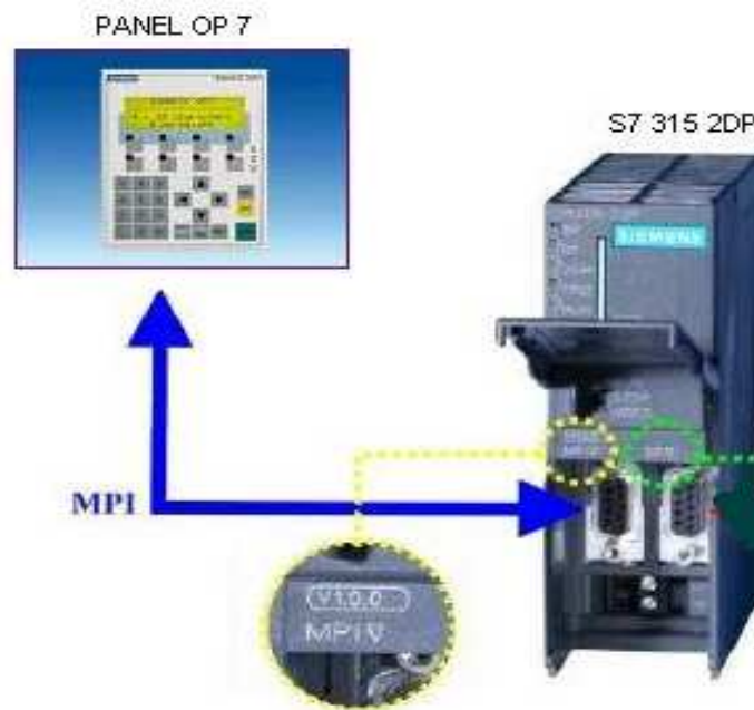
Figura 4.8 Conexión de red entre el PLC y el panel operador OP7
