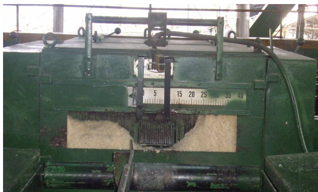
Figura 2.13 Ampliación mecánica para la guía visual de la apertura - máquina CB 10
