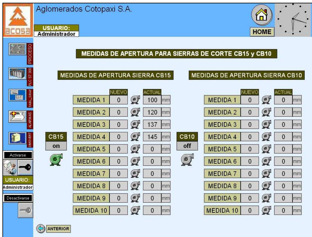
Figura 4.15 Parametrización de medidas de apertura
