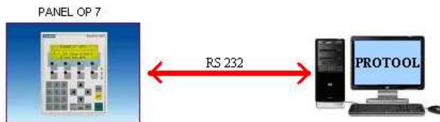
Figura 4.9 Conexión para la transferencia hacia el OP7
