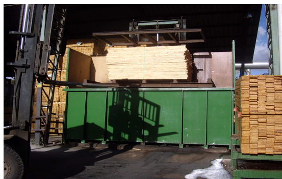
Figura 1.1.7 Depósito con líquidos para el preservado del producto
