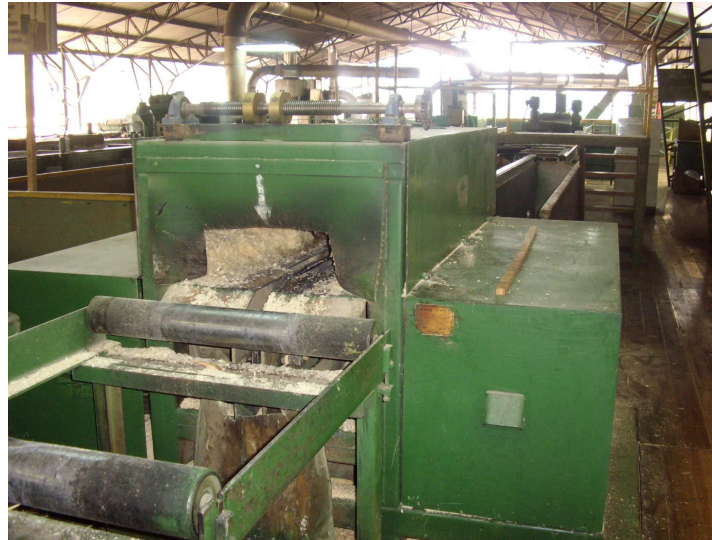
Figura 1.2.2 Sierra para corte de recuperación etapa 1 - máquina CB 15
