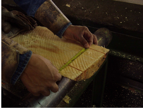
Figura 1.1.14 Mediciones de prueba para establecer el ancho de corte
