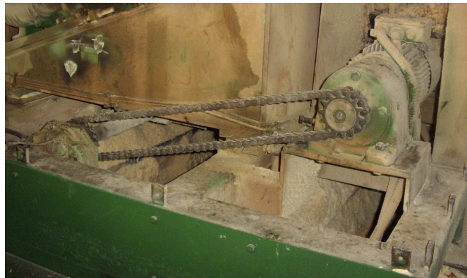
Figura 2.3 Motor reductor para apertura de discos – máquina CB 15
