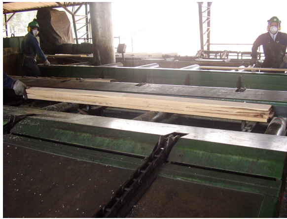
Figura 1.1.17 Acumulación de tablas para ingresarlas a la máquina CB 10
