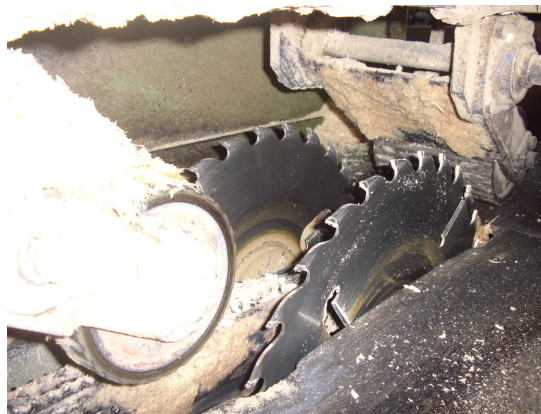
Figura 1.1.13 Discos de corte – máquina CB 15
