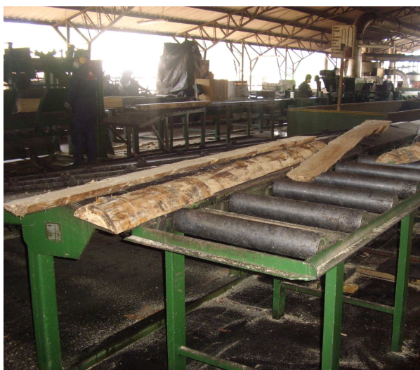
Figura 1.1.11 Pedazos laterales generados del corte principal
