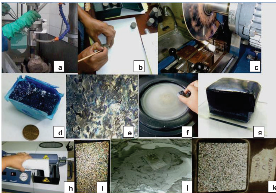
Figura 42 - Tratamiento de muestras para realizar láminas delgadas. a) Extracción de plug b) Codificación de plugs. c) Corte en prisma rectangular d) Tinción selectiva e) Cara del prisma sin rayones vista al binocular f) Desbastado de muestra g) Muestra pegada al portaobjetos h) Corte en la rectificadora i) Lámina con espesor muy grueso j) Pulimento de lámina k) Lámina terminada vista en lámpara de luz polarizada.
