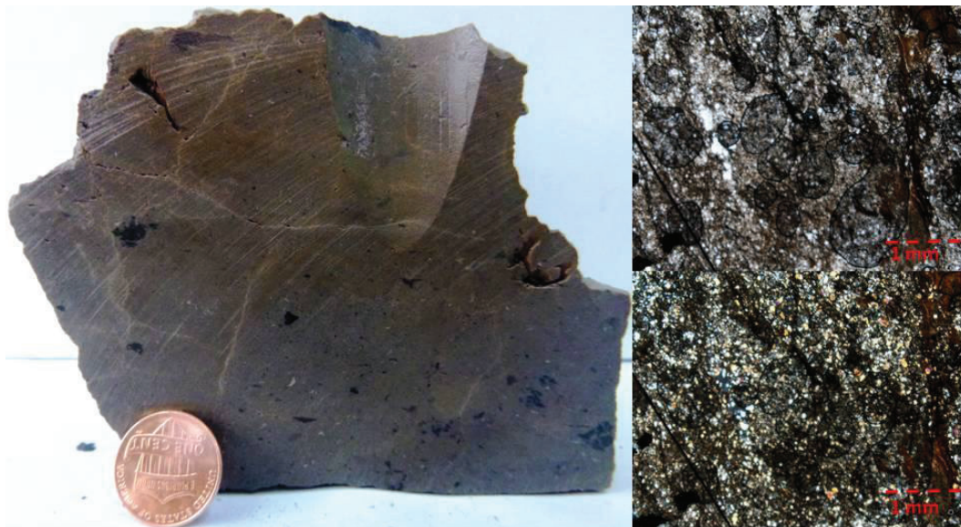
Figura 55 - Facies LC a) Muestra de mano b) Lámina delgada sin nicoles, c) Lámina delgada con nicoles.
