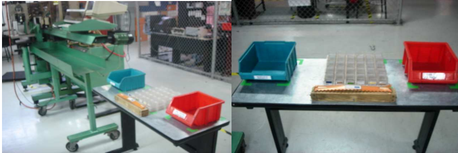
Figura 3.2.2. Estación de armado mandos con mejora
