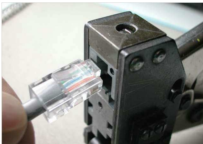
Fig. 4.8 Construcción de Patch Cord Fuente: Autores de este proyecto
