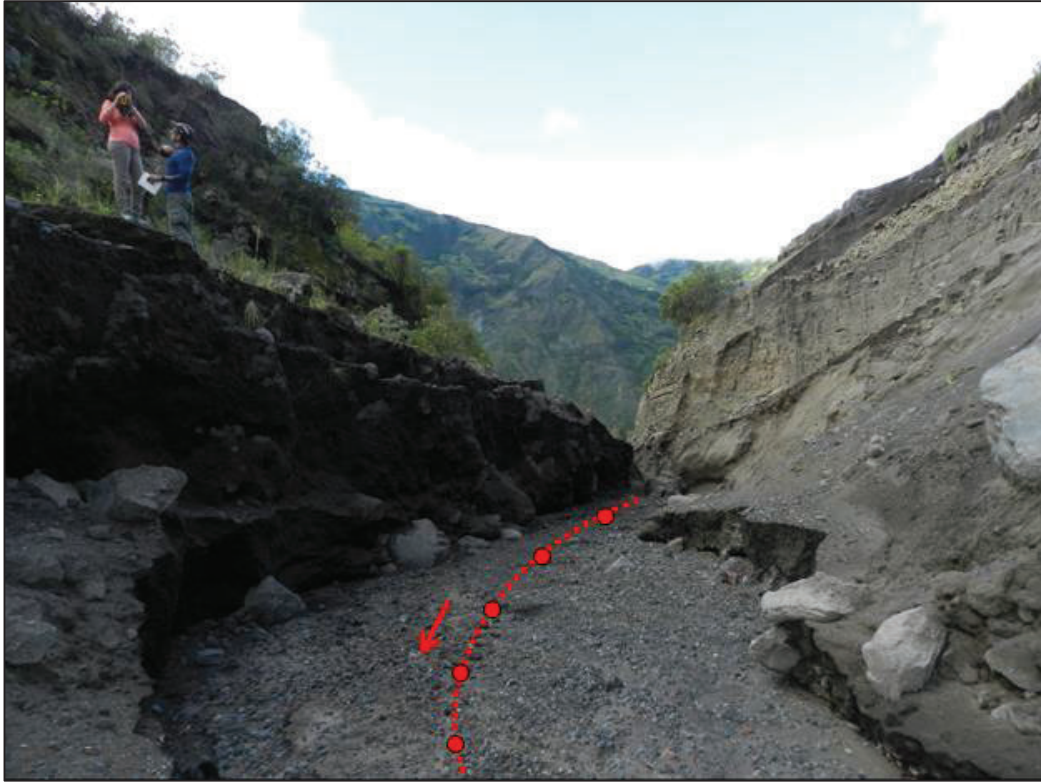
Figura 4.11: Medición en el campo de la ubicación de varios puntos a lo largo de una curva transitada por el lahar. La línea de puntos roja representa el eje de la trayectoria seguida por el lahar que se toma como referencia.
