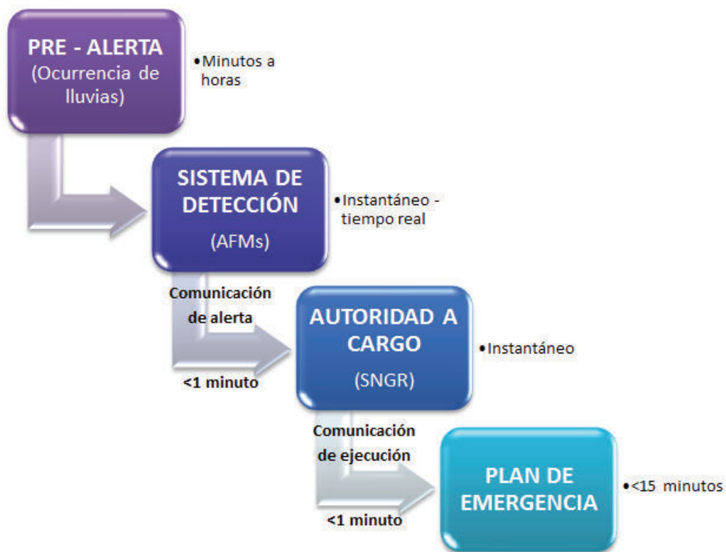
Figura 3.10: Esquema básico del funcionamiento del Sistema de Alerta Temprana ejecutado en el volcán Tungurahua para ocurrencia de lahares (Modificado de Andrade et al., 2006).
