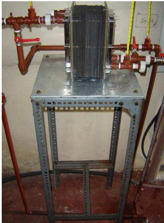
**Figura 4.7 Mesa soporte con Intercambiador de calor.**
