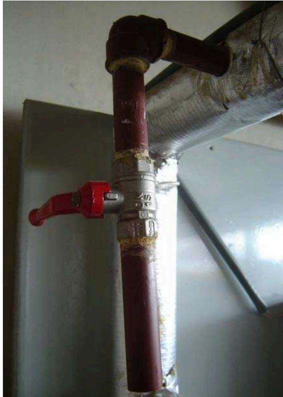
**Figura 4.6 Adaptación para medir el caudal del fluido caliente.**
