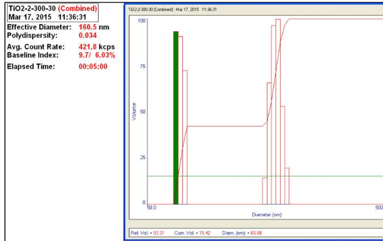
**Figura A V 5** Análisis obtenido mediante DLS para una muestra de nanopartículas de TiO<sub>2</sub> sintetizada por el método 2 calcinada a 300 °C por 30 min
