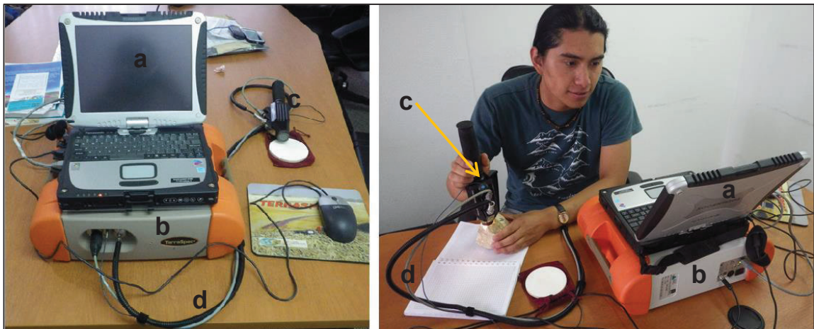
Foto 4.1 Equipo TerraSpec con todos sus elementos: a) computadora incluida con el equipo b) espectrómetro c) sonda d) cables de datos, fibra óptica y red.
