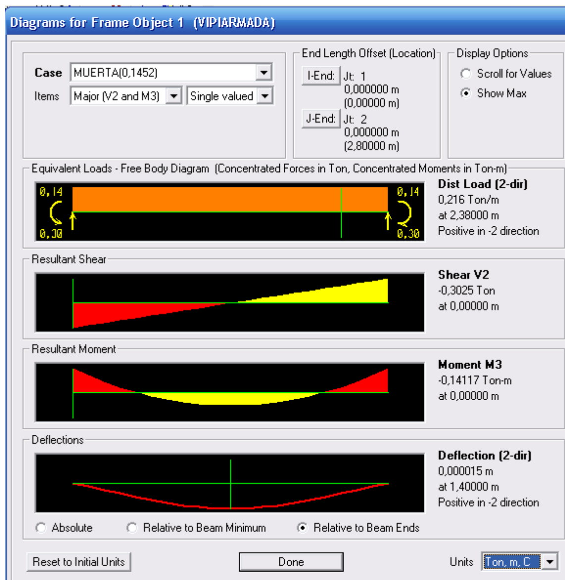
Figura 4. 58 Diagrama de Cortantes y Momentos máximos para carga muerta para la viga transversal.
