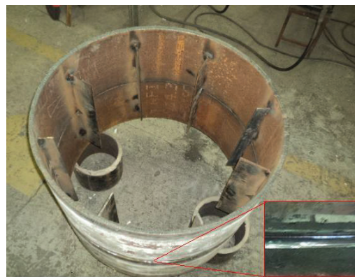
(b) Unión y alineación de nipples biselados
