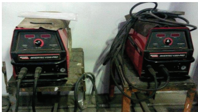
Figura 3.4 Equipo de soldadura por arco INVERTEC V350-PRO
