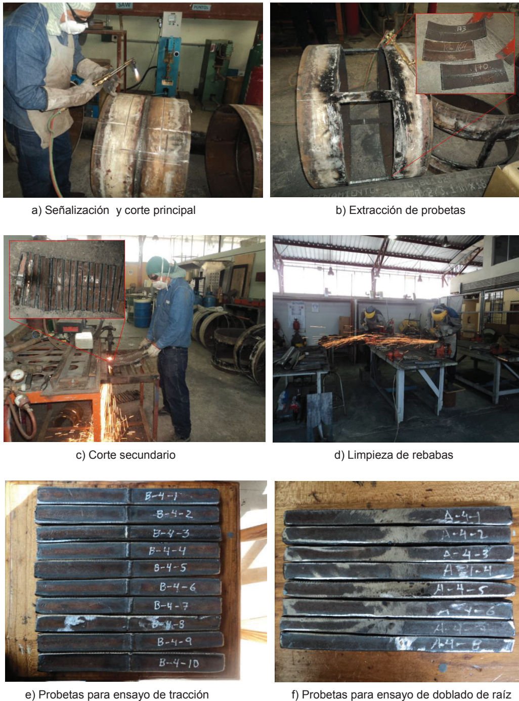
Figura 3.9 Obtención de las probetas de ensayo
