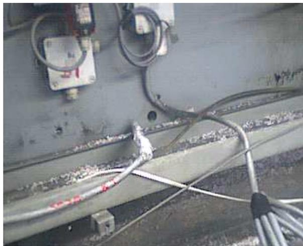
Fig.18 Cable multipar y cajetín unido a la máquina, marcados con pintura permanente diferente al color de la máquina.
