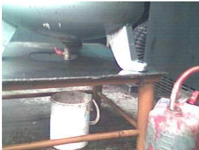
Fig.23 Purgado del tanque de aire.
