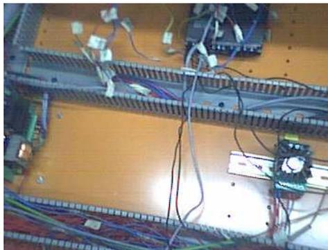
Fig.11 Cables codificados en el tablero de control de la máquina.
