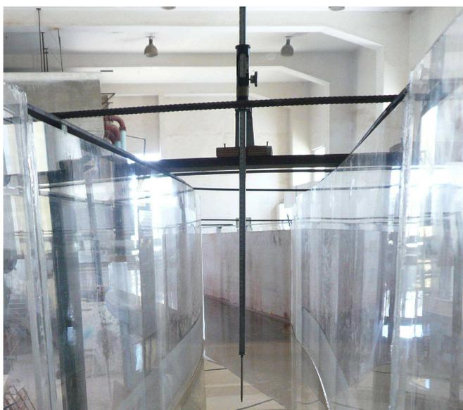
FOTOGRAFÍA N° 3.6 Limnómetro para medición de calados en canales Fase AB y C
