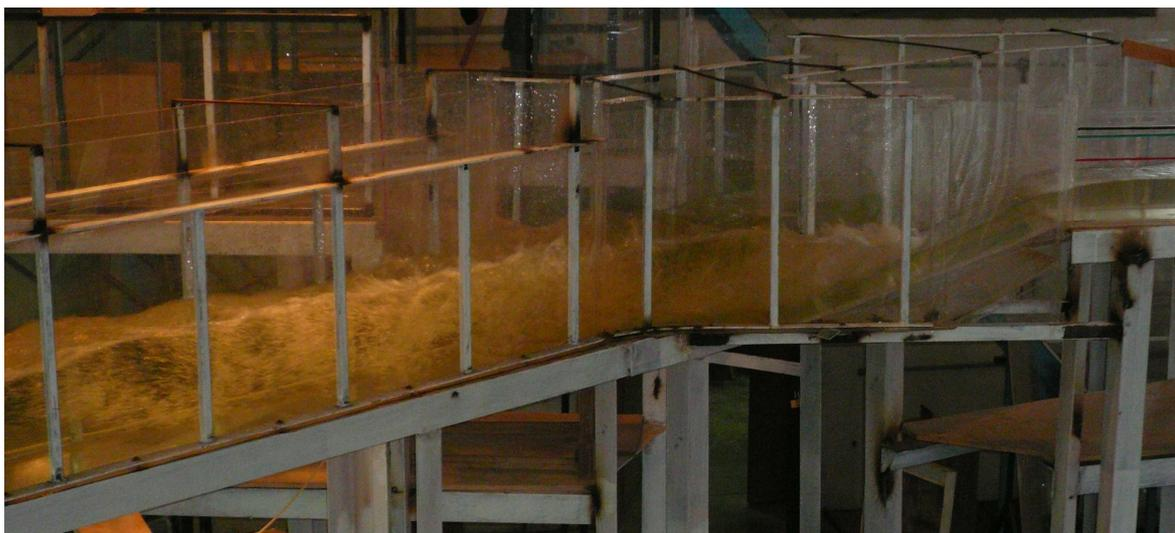
FOTOGRAFÍA N° 7.1. Resalto hidráulico en la rampa de la Fase AB
