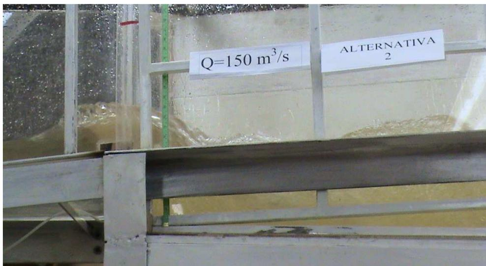
FOTOGRAFÍA N° 6.4. Resalto hidráulico ahogado al inicio de la cámara
