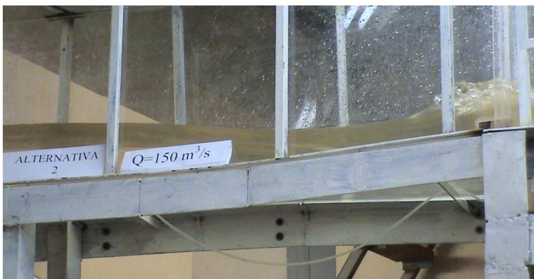
FOTOGRAFÍA N° 6.3. Cambio de régimen a la entrada de la cámara
