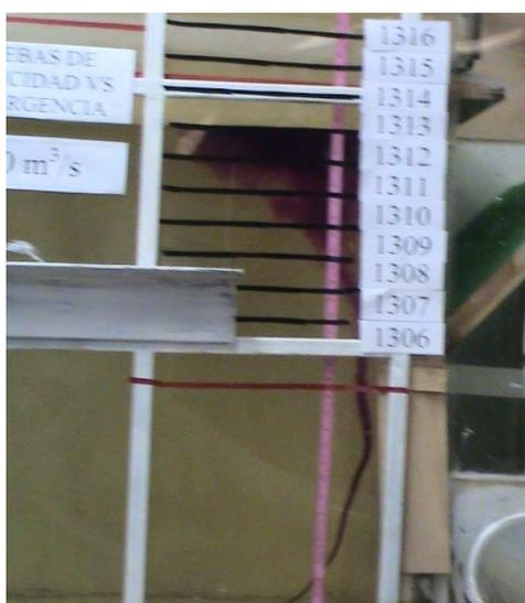
FOTOGRAFIA No 5.1. Pruebas sumergencia vs. vorticidad. Caudal ensayado  $80\text{m}^3/\text{s}$ , cota 1313, presencia de vórtices intermitente a partir de esta cota.
