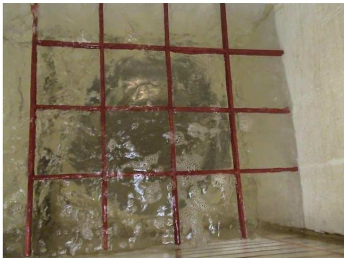
FOTOGRAFIA No 5.3. Alternativa 2: No hay presencia de vórtices. Se observa que esta malla tiene efectos definitivos en el control y eliminación de vórtices.
