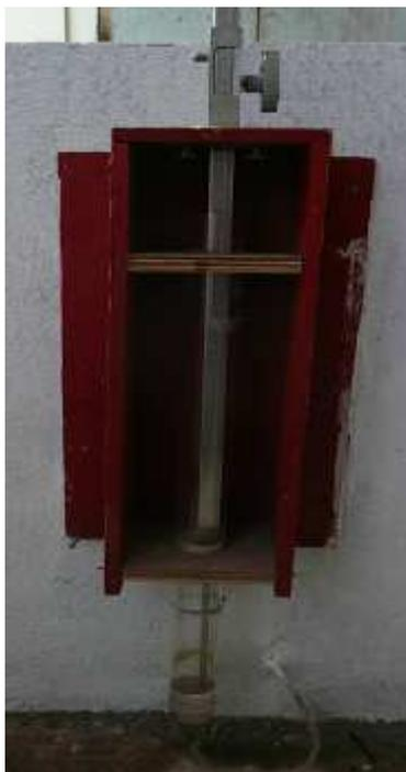
FOTOGRAFÍA N° 3.7 Limnómetro para la medición de calados en canales de descarga Fase AB, C y C.I
