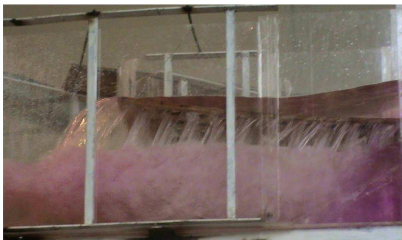
FOTOGRAFÍA N° 7.5. Funcionamiento del dissipador con orificios de 5cm de diámetro
