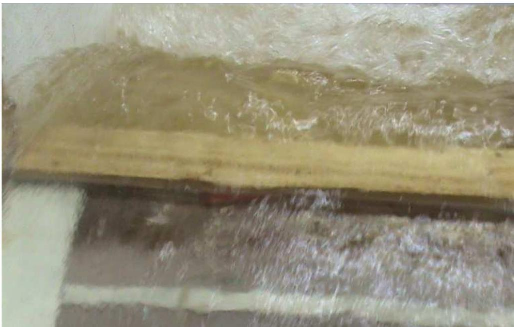
FOTOGRAFÍA N° 6.1. Pruebas con umbrales de fondo en la entrada a la cámara de interconexión
