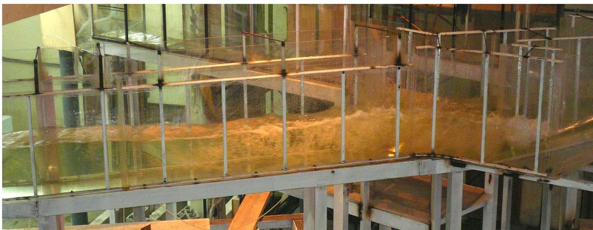
FOTOGRAFÍA N° 7.2. Turbulencia transmitida hacia aguas abajo del resalto hidráulico
