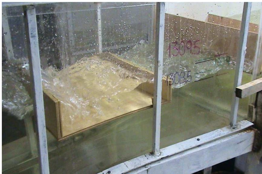
FOTOGRAFÍA N° 7.3. Turbulencia entre los dos rompeolas la transición de entrada a la cámara
