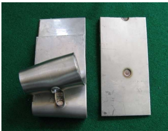
Figura 4. 21. Probetas de 2.0 mm, después de realizado el ensayo de desgarre y cincel.
