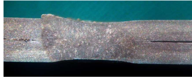
Figura 4. 5. Macrografía del punto de soldadura en la probeta de 1 mm a 10x.
