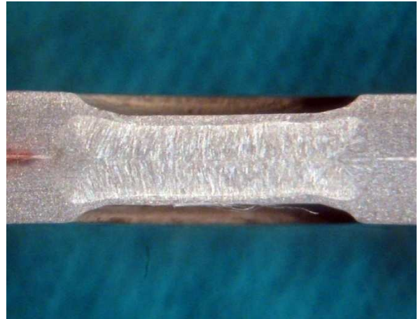
Figura 4. 18. Macrografía del punto de soldadura en la probeta de 1.5 mm (10x)
