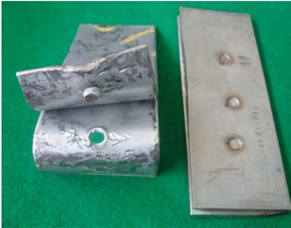
Figura 4. 25. Probetas de 2.5 mm, después de realizado el ensayo de desgarre y cincel.
