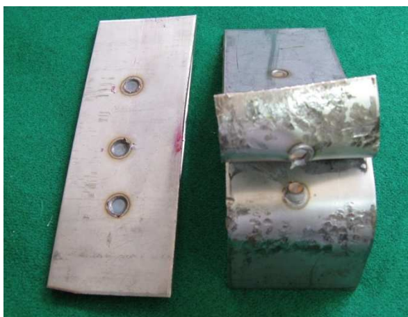
Figura 4. 29. Probetas de 3.0 mm, después de realizado el ensayo de desgarre y cincel.
