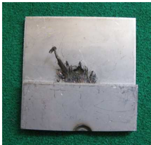
Figura 2. 18. Explosión interna en placas
