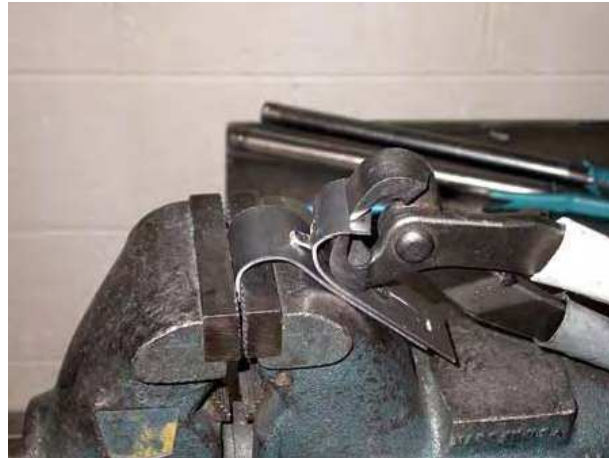
Figura 2. 12. Prueba de desgarre con alicate.
