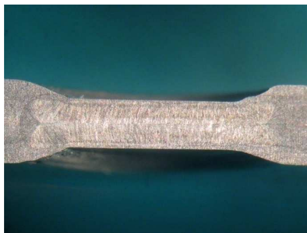
Figura 4. 14. Macrografía del punto de soldadura en la probeta de 1.0 mm (10x)
