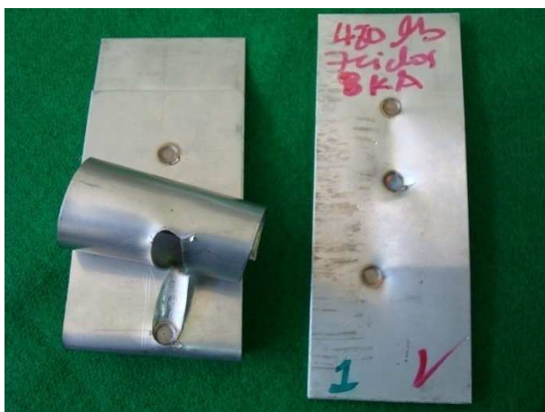
Figura 4. 13. Probetas de 1.0 mm, después de haber realizado el ensayo de desgarre y cincel.
