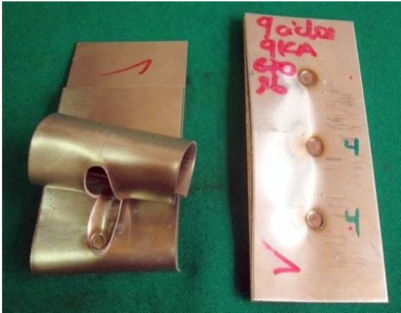
Figura 4. 17. Probetas de 1.5 mm, después de realizado el ensayo de pelado y de cincel.
