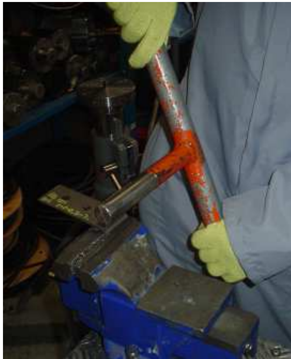
Figura 3. 11. Forma de realizar la prueba de desgarre.
