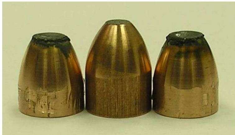
Figura 3. 8. Electrodo con vida útil cumplida.
