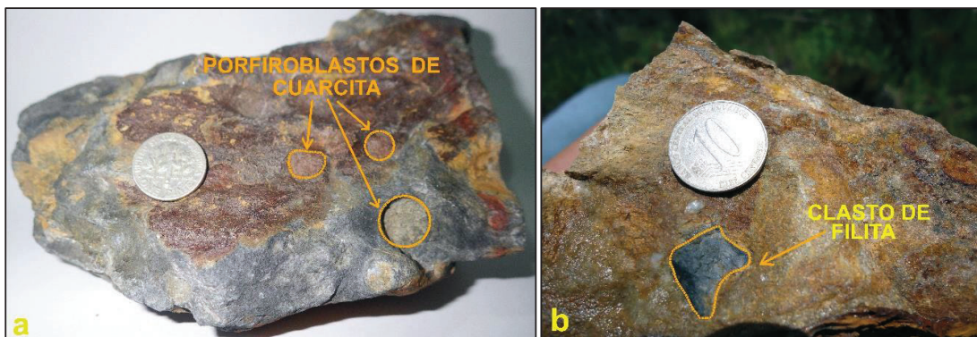
Figura 3.22 a) Filita (EYT-035) con porfiroblastos redondeados de cuarcita (UTM: 772961/ 9798160), b) Cuarcita (EYT-034) con fragmentos de filita en su interior (UTM: 772913/ 9798259)
