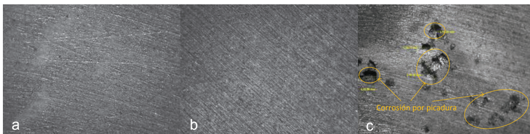
Figura 3.42. Micrografías ópticas de los sustratos de aluminio comercial con recubrimiento y sin recubrimiento después del ensayo en la cámara salina
