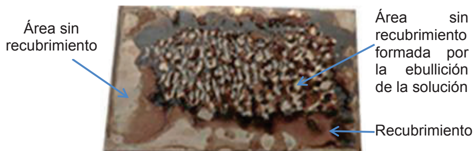
Figura 3.11. Recubrimiento densificado a una tasa de calentamiento de 10 °C/min
