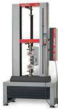
Fig. 2.2: Máquina de Ensayos Zwick Roell modelo ProLine 13
