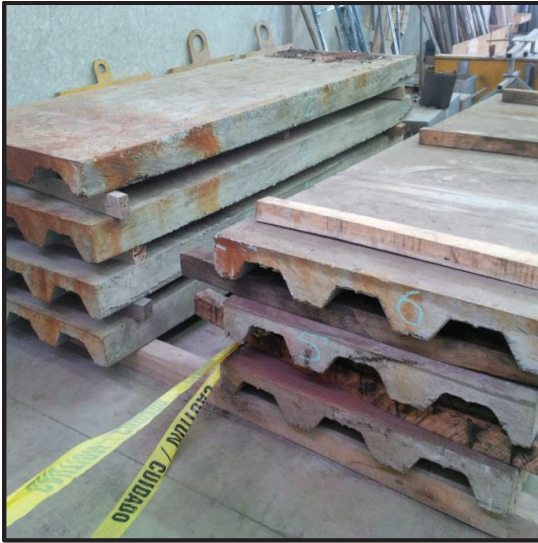
FOTOGRAFÍA 4.15. PROBETAS HORMIGONADAS PARA ENSAYAR.
