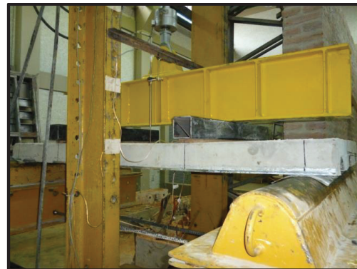
FOTOGRAFÍA 5.8. CICLOS DE CARGA Y FALLAS DEL ENSAYO TIPO 2 PLACA P4; LOSETA, PLACA DECK + CARPETA DE HORMIGÓN.
