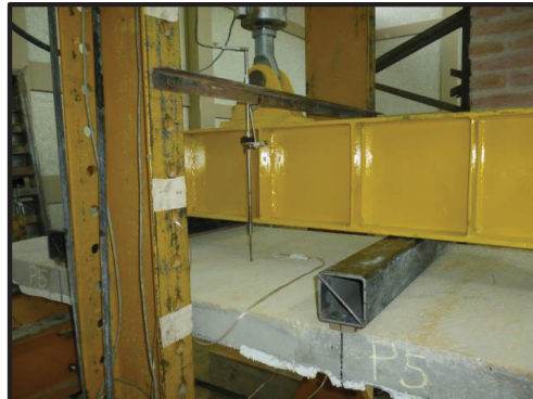
FOTOGRAFÍA 5.12. CICLOS DE CARGA Y FALLAS DEL ENSAYO TIPO 3 PLACA P5; MOMENTO POSITIVO, LOSETA + MALLA ELECTROSOLDADA + NELSON STUD.
