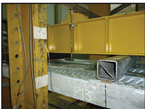
FOTOGRAFÍA 5.15. CICLOS DE CARGA Y FALLAS DEL ENSAYO TIPO 4 PLACA P13; MOMENTO NEGATIVO, LOSETA + MALLA ELECTROSOLDADA + NELSON STUD, (FLEXIÓN NEGATIVA).
