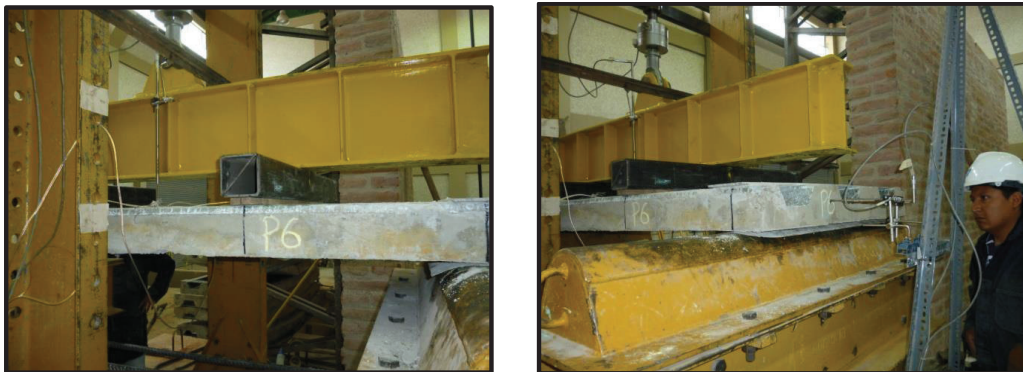
FOTOGRAFÍA 5.16. CICLOS DE CARGA Y FALLAS DEL ENSAYO TIPO 4 PLACA P6; MOMENTO NEGATIVO, LOSETA + MALLA ELECTROSOLDADA + NELSON STUD, (FLEXIÓN NEGATIVA).
