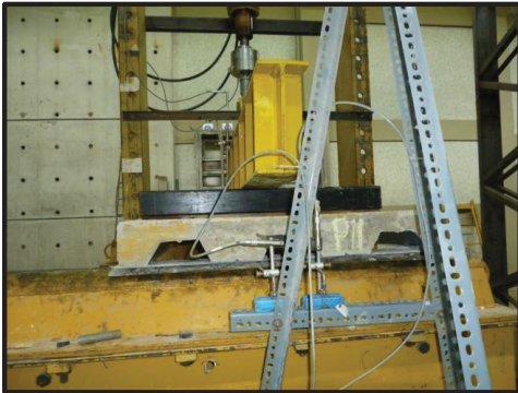
FOTOGRAFÍA 5.10. CICLOS DE CARGA Y FALLAS DEL ENSAYO TIPO 3 PLACA P11; MOMENTO POSITIVO, LOSETA + MALLA ELECTROSOLDADA + NELSON STUD.
