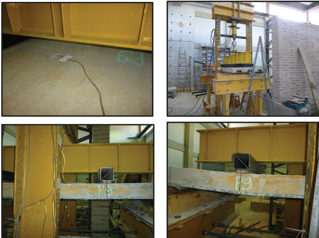
FOTOGRAFÍA 5.9. CICLOS DE CARGA Y FALLAS DEL ENSAYO TIPO 2 PLACA P9; LOSETA, PLACA DECK + CARPETA DE HORMIGÓN.
