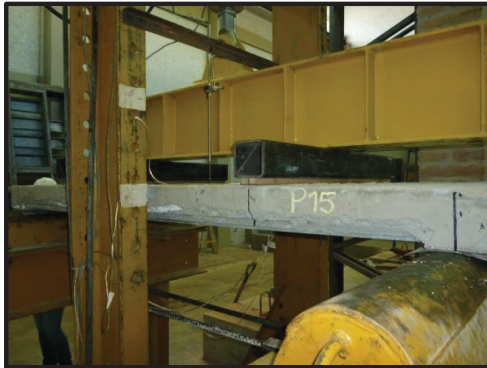
FOTOGRAFÍA 5.13. CICLOS DE CARGA Y FALLAS DEL ENSAYO TIPO 3 PLACA P15; MOMENTO POSITIVO, LOSETA + MALLA ELECTROSOLDADA + NELSON STUD.
