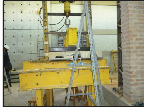
FOTOGRAFÍA 5.13. CICLOS DE CARGA Y FALLAS DEL ENSAYO TIPO 3 PLACA P15; MOMENTO POSITIVO, LOSETA + MALLA ELECTROSOLDADA + NELSON STUD.
