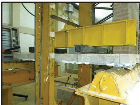
FOTOGRAFÍA 5.12. CICLOS DE CARGA Y FALLAS DEL ENSAYO TIPO 3 PLACA P5; MOMENTO POSITIVO, LOSETA + MALLA ELECTROSOLDADA + NELSON STUD.
