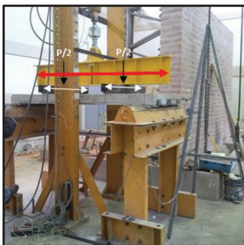
FOTOGRAFÍA 5.6. UBICACIÓN DE APOYOS Y CARGA EN LA PROBETA
