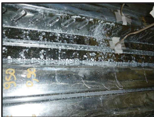
FOTOGRAFÍA 5.8. CICLOS DE CARGA Y FALLAS DEL ENSAYO TIPO 2 PLACA P4; LOSETA, PLACA DECK + CARPETA DE HORMIGÓN.
