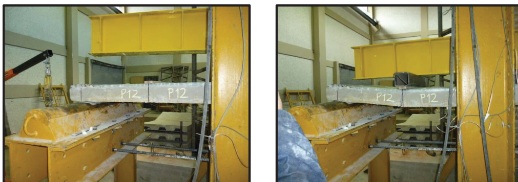
FOTOGRAFÍA 5.14. CICLOS DE CARGA Y FALLAS DEL ENSAYO TIPO 4 PLACA P12; MOMENTO NEGATIVO, LOSETA + MALLA ELECTROSOLDADA + NELSON STUD, (FLEXIÓN NEGATIVA).
