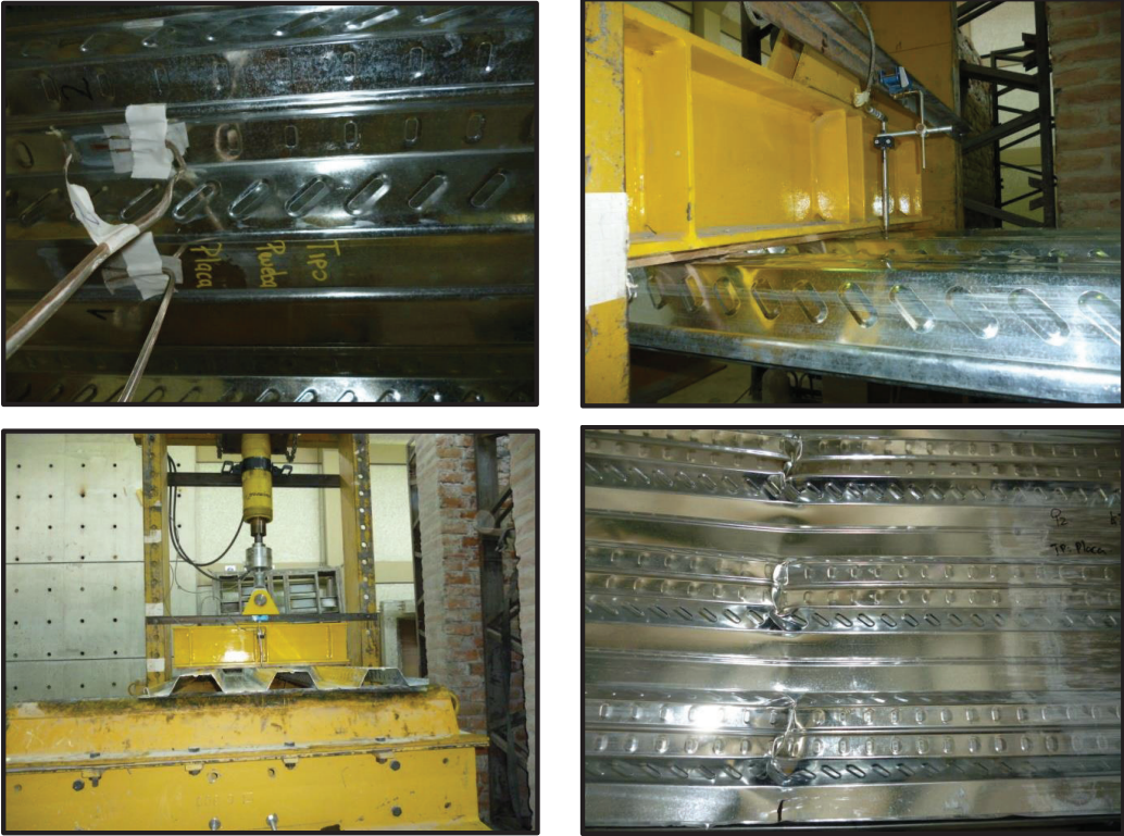
FOTOGRAFÍA 5.4. CICLOS DE CARGA Y FALLAS DEL ENSAYO TIPO 1 PLACA P2; PLACA ENCOFRADO, PLACA DECK SOLA.
