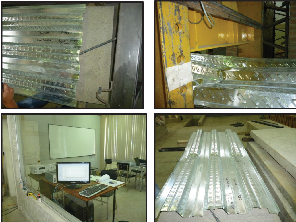
FOTOGRAFÍA 5.5. CICLOS DE CARGA Y FALLAS DEL ENSAYO TIPO 1 PLACA P20; PLACA ENCOFRADO, PLACA DECK SOLA.
