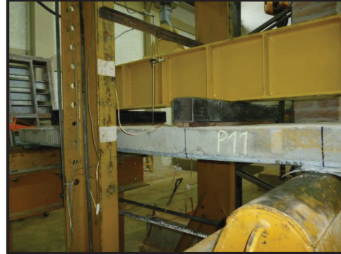
FOTOGRAFÍA 5.10. CICLOS DE CARGA Y FALLAS DEL ENSAYO TIPO 3 PLACA P11; MOMENTO POSITIVO, LOSETA + MALLA ELECTROSOLDADA + NELSON STUD.
