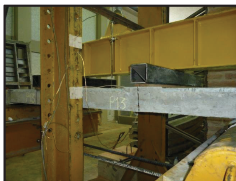
FOTOGRAFÍA 5.15. CICLOS DE CARGA Y FALLAS DEL ENSAYO TIPO 4 PLACA P13; MOMENTO NEGATIVO, LOSETA + MALLA ELECTROSOLDADA + NELSON STUD, (FLEXIÓN NEGATIVA).
