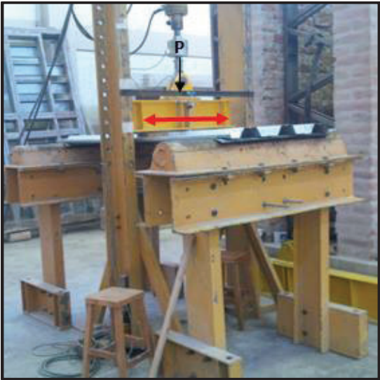
FOTOGRAFÍA 5.1. UBICACIÓN DE APOYOS Y CARGA EN LAS PROBETA DEL ENSAYOS TIPO 1; PLACA ENCOFRADO, PLACA DECK SOLA.
