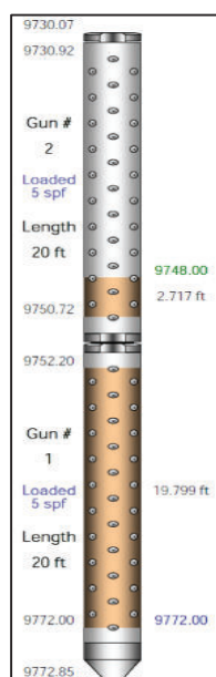
FIGURA 2.5.2: DIAGRAMA DE LOS CAÑONES DEL POZO APP-159
