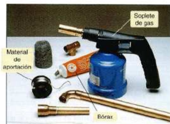
Fig. 3.10 Equipo necesario para la soldadura fuerte
