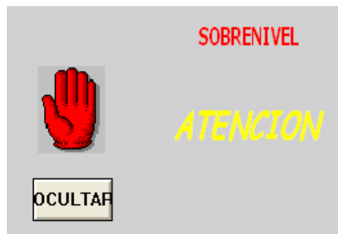
Figura. 4.1.2.1. Alarma generada en el módulo de nivel debido a un sobre nivel de líquido en el tanque principal.
