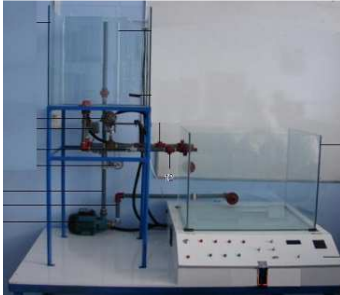
Figura 2.1 Módulo Didáctico de Control de Nivel de Líquidos.
