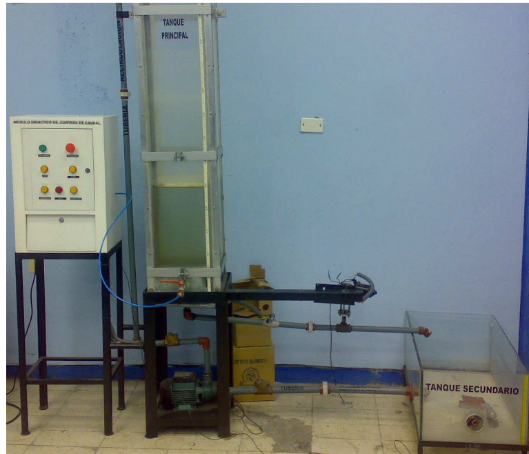
La Figura 2.1 Módulo Didáctico de Control de Caudal.
