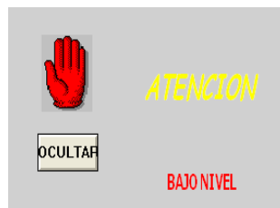
Figura. 4.1.1.1. Alarma generada en el módulo de control de caudal debido a un bajo nivel de líquido en el tanque principal.
