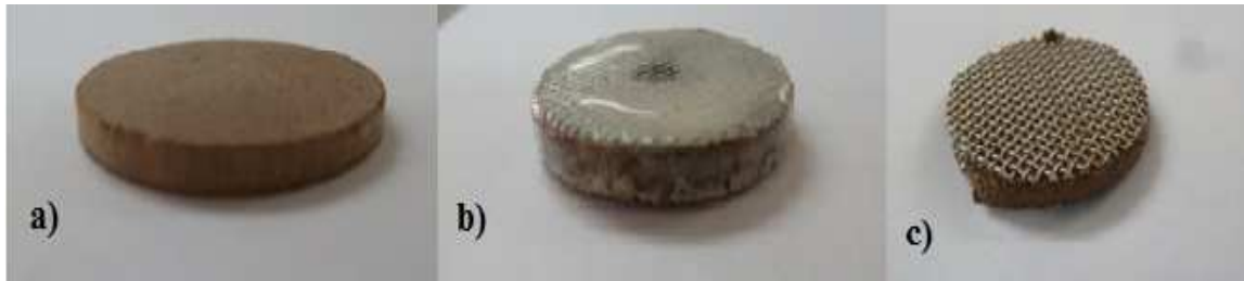
Figura 4.28 a) Pastilla Original b) Hinchamiento con Lodo base amina y c) Hinchamiento con Agua Elaborado por Pedro Orbe
