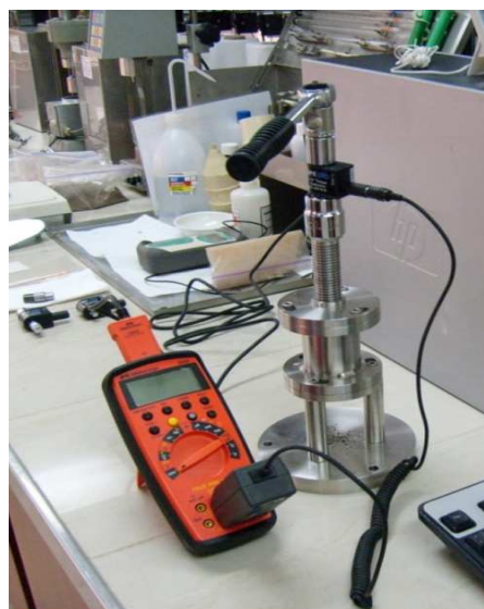
Figura 4.4 Equipo de Dureza al Humectar Elaborado por Pedro Orbe
