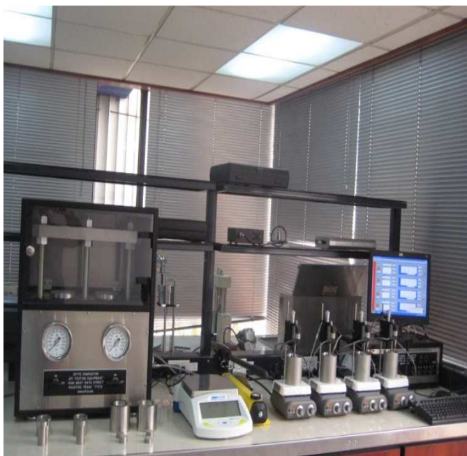
Figura 3.10 Equipo dinámico de Hinchamiento Lineal Fuente: M-I SWACO
