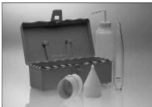
Figura 3.5 Juego para determinar contenido de arena Fuente: M-I SWACO
