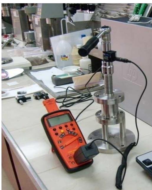
Figura 3.12 Equipo de Dureza al Humectar Fuente: M-I SWACO
