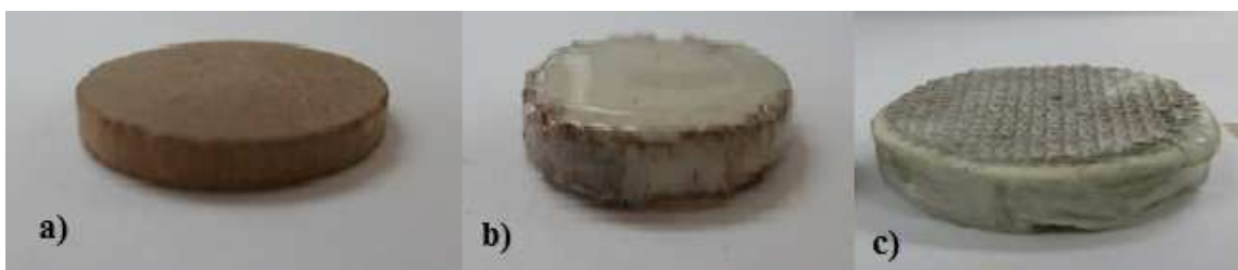
Figura 4.22 a) Pastilla Original b) Hinchamiento con Lodo base amina y c) Hinchamiento con Agua Elaborado por Pedro Orbe
