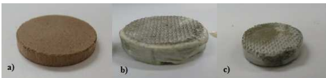
Figura 4.19 a) Pastilla Original b) Hinchamiento con Lodo base amina y c) Hinchamiento con Agua Elaborado por Pedro Orbe
