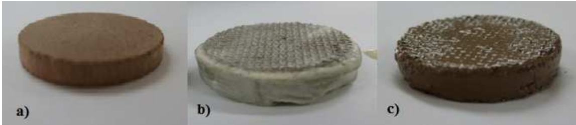
Figura 4.24 a) Pastilla Original b) Hinchamiento con Lodo base amina y c) Hinchamiento con Agua Elaborado por Pedro Orbe
