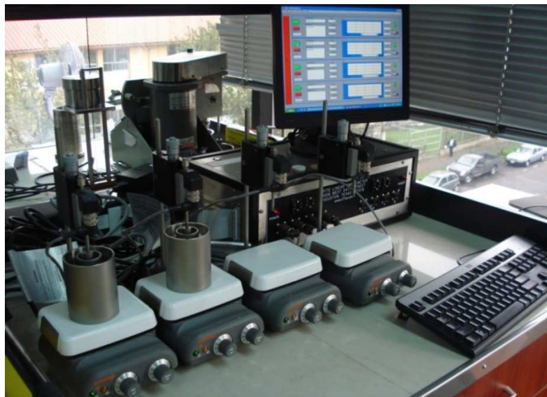
Figura 4.15 Equipo Dinámico de Hinchamiento Lineal Fuente: M-ISWACO
