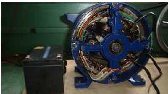
Figura 3.6 Generador y batería de AC
