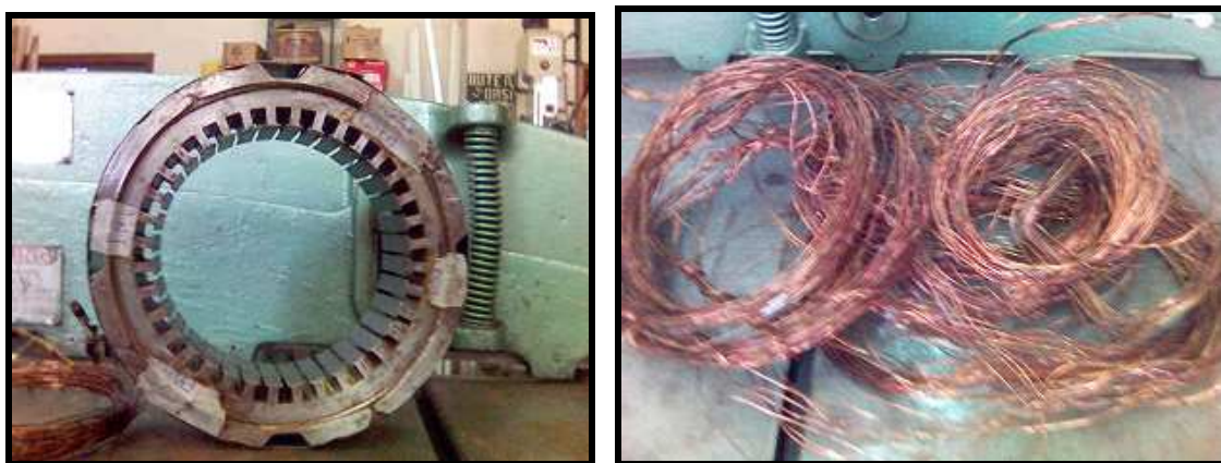
FIGURA 3.1 Desmontaje del generador
