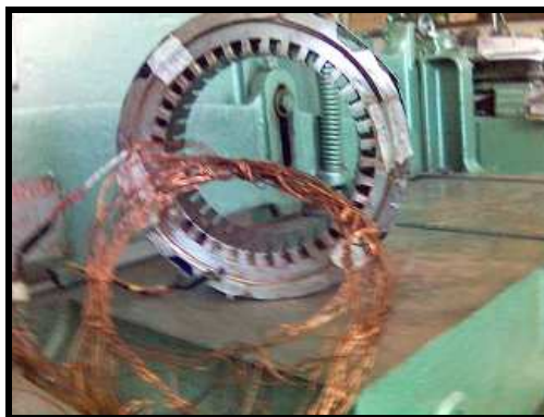
FIGURA 3.2 Armadura y alambre de las bobinas del generador
