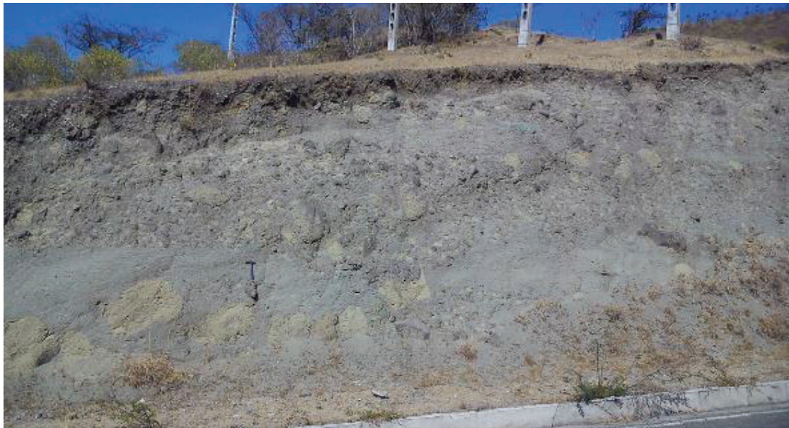
Fotografía 3.67: Brechas volcánicas poco consolidadas con clastos métricos de color anaranjado en matriz arenosa poco consolidada, del Mioceno.
