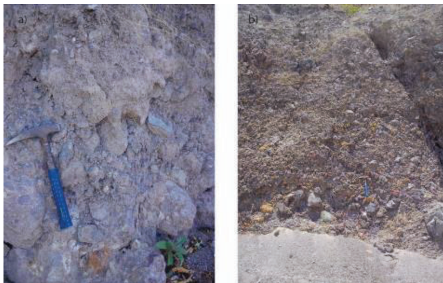
Fotografía 3.23: Conglomerados y brechas volcánicas atribuidos a la Mb. Volcano-sedimentos: a) Conglomerado en el punto UTM: 0661414 / 9531618; b) Brecha clasto soportada (UTM: 0660323 / 9538334).
