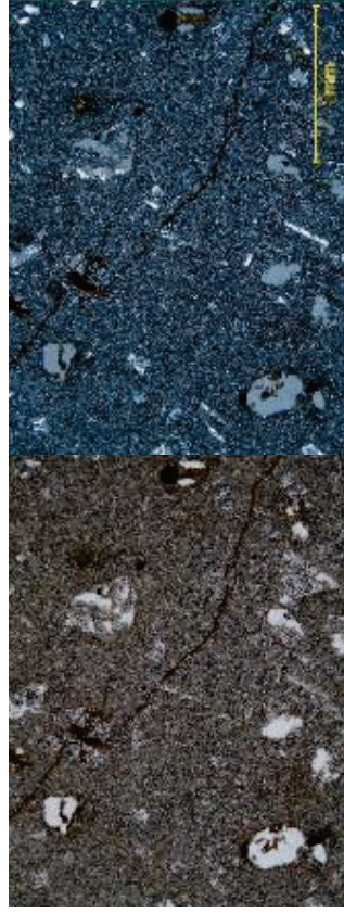
Fotografías tomadas con aumento 2,5x; imagen izquierda tomada con luz normal polarizada; imagen derecha tomada con nicoles cruzados. Se observa cristales de plagioclasa en una matriz de ceniza y microcristales de plagioclasa y piroxeno.
