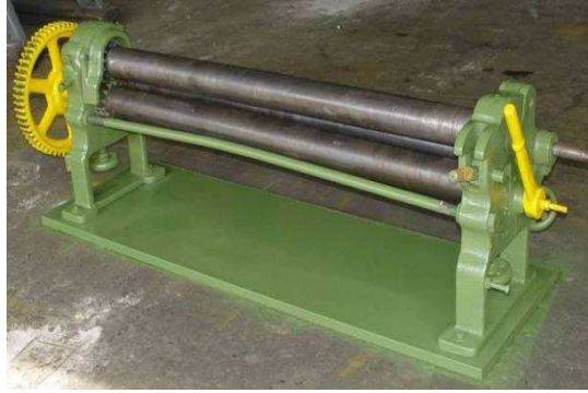
Figura 3-10 Roladora Manual Fuente: http://www.maquiventa.com
