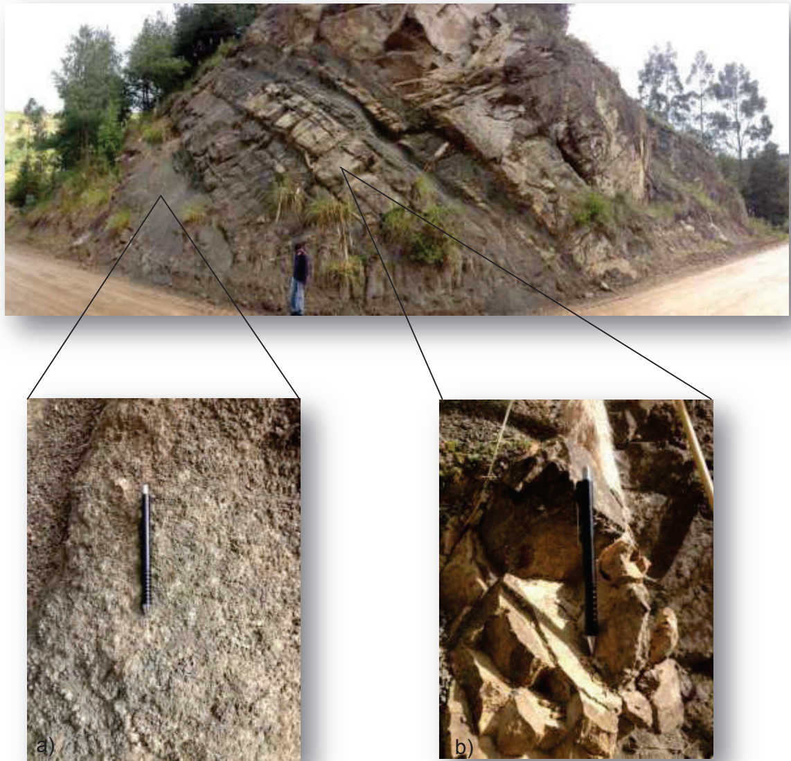
Figura 3.36 Secuencia de lutita - limo y arenisca de la Formación Quingeo, vía Quingeo - Cumbe, sector Macas, UTM: 7286554 / 9664130.
