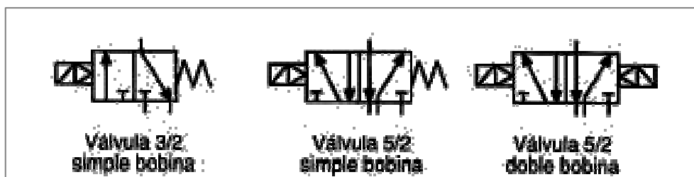
Fig. 4a Símbolos de válvulas eléctricas
