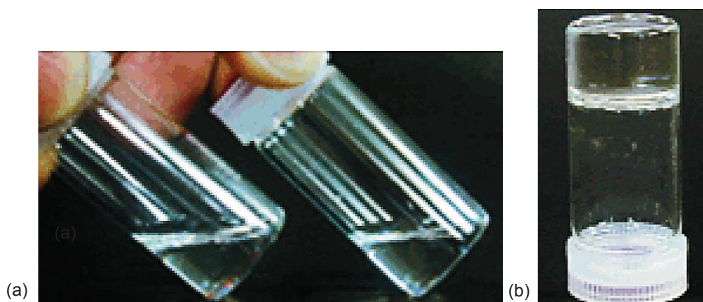
Figura 3.1. Apariencia de (a) una solución caracterizada como viscosa y (b) una solución caracterizada como formadora de gel (Adaptado de Suzuki et al., 2003, p. 8623)
