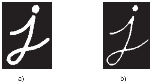
Figura 3.9 a) Imagen original b) Imagen aplicando la erosión [35]
