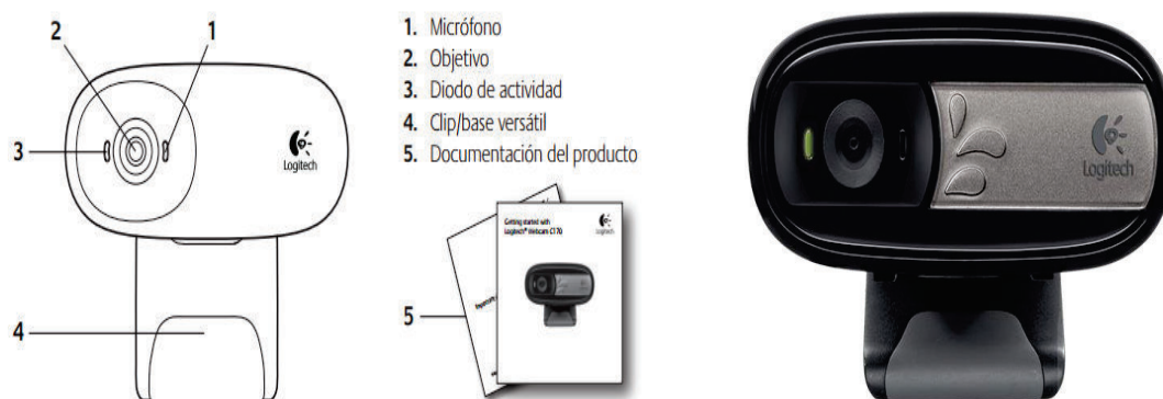
Figura 2.10 Partes de la Cámara Logitech C170 [22]
