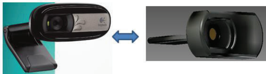
Figura 2.21. Comparación entre webcam Logitech C170 (Izquierda) y su diseño en Inventor (Derecha)
