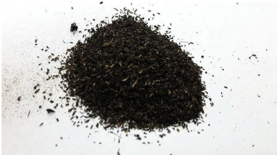
**Figura 3.21.** Muestra de *hydrochar* obtenido a las condiciones de optimización
