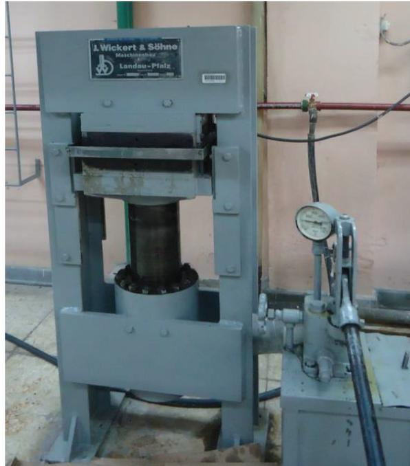
**Figura 2.4.** Prensa utilizada en el proceso de prensado del *hydrochar*
