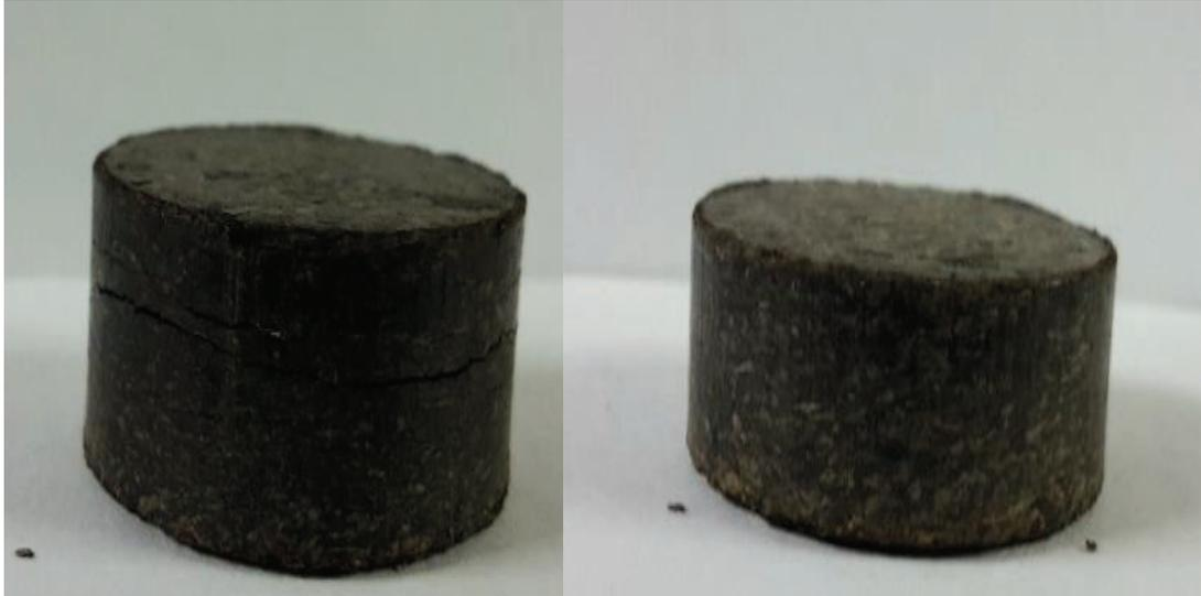
**Figura 3.23.** Fotografías de los densificados obtenidos en la prensa hidráulica después de realizar los tratamientos T3 y T4
