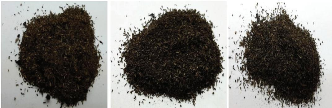
**Figura 3.4.** Fotografías de los carbonizados obtenidos de la carbonización hidrótermica después de realizar los tratamientos T4, T5 y T6
