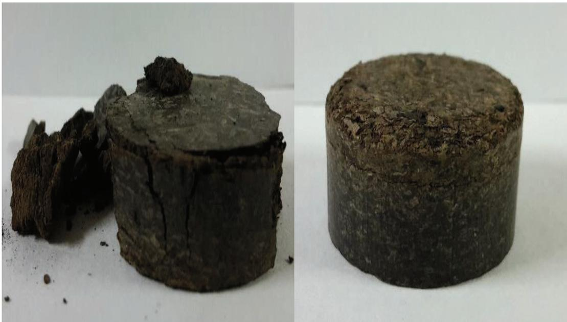
**Figura 3.22.** Fotografías de los densificados obtenidos en la prensa hidráulica después de realizar los tratamientos T1 y T2
