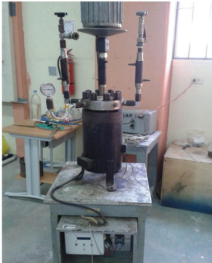
**Figura 2.2.** Equipo para la carbonización hidrotérmica de la cascarilla de arroz
