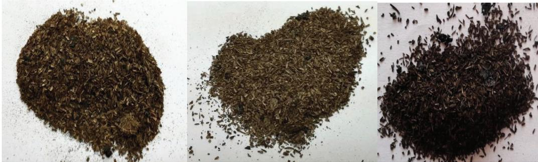
**Figura 3.3.** Fotografías de los carbonizados obtenidos en la carbonización hidrótermica después de realizar los tratamientos T1, T2 y T3
