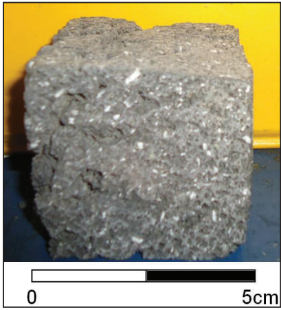
Figura 4.20. Muestra de una escoria antigua cortada en forma de cubo de 5cm por lado. Piroclasto tomado de la muestra TUNG-JG-001-A, Coordenadas: 792524, 9843722, WGS 84, ZONA 17M.
