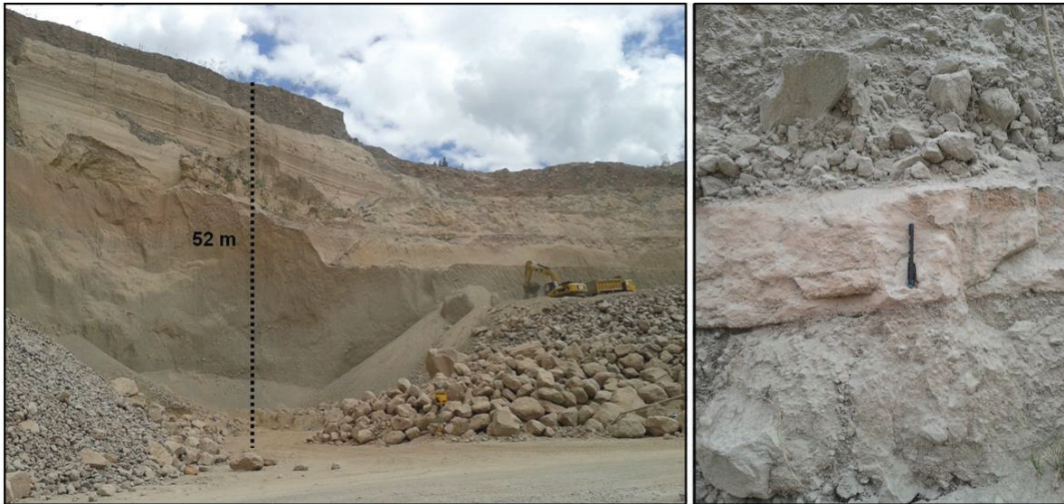
Figura 3.16. Depósito de “bloques y ceniza” con una potencia de 52m. Localización canteras del Complejo Volcánico Pululahua (CVP). Fotografía de un depósito del “bloques y ceniza” del CVP, nótese la capa intermedia de color rosado corresponde a un flujo ignimbrítico (Tomada de Vásquez F., 2015).
