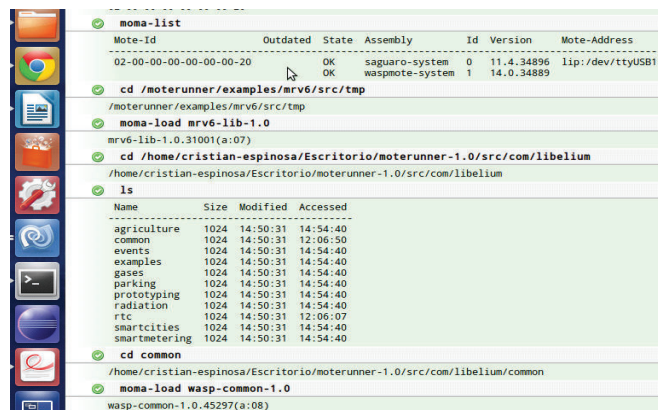
Figura A-55 Carga de las librerías mrv6-lib y wasp-common
