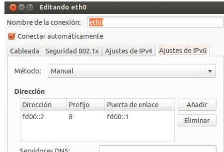
Figura A-75 Configuración de una dirección IPv6 a la PC que ejecuta el túnel
