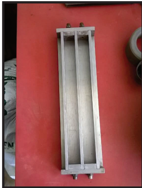
Figura AIV.8. Moldes utilizados en los ensayos de expansión en autoclave, contracción por secado y resistencia a los sulfatos
