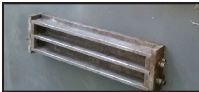
Figura AIV.9. Moldes utilizados en los ensayos de expansión en autoclave, contracción por secado y resistencia a los sulfatos
