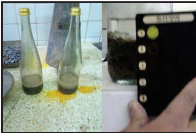
Figura AII. 2. Ensayo de contenido orgánico del agregado fino
