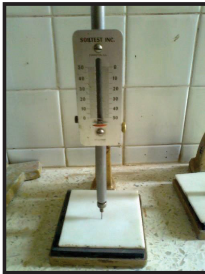
Figura AIV. 1. Aparato de Vicat utilizado en los ensayos de tiempo de fraguado
