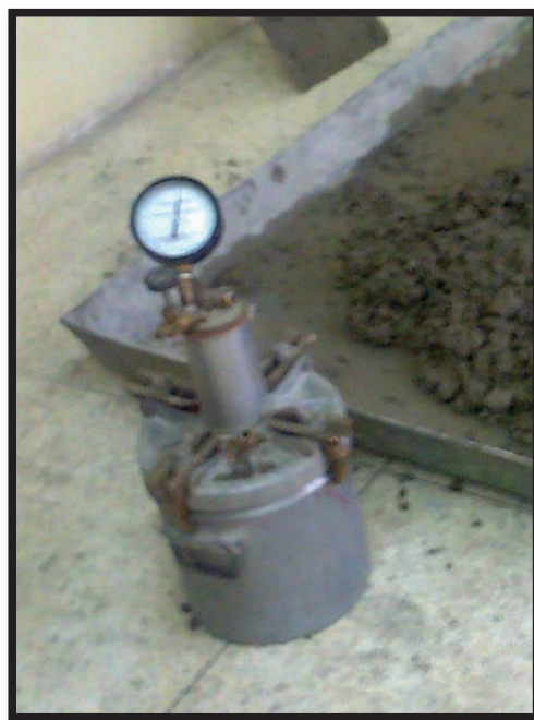
Figura AIV.7. Equipo utilizado para medir el contenido de aire en el mortero
