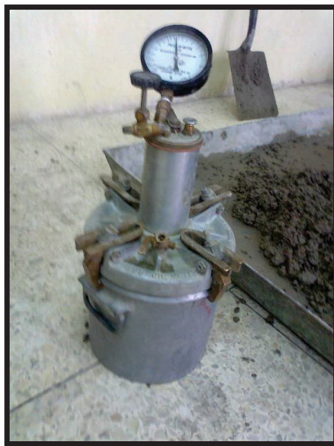
Figura AIV.2. Equipo utilizado para medir el contenido de aire en hormigón
