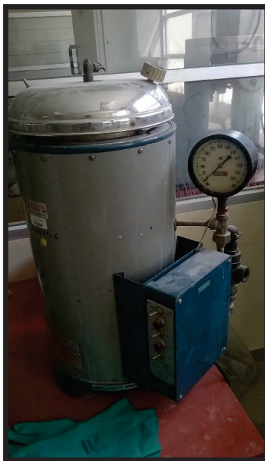
Figura AIV.5. Autoclave utilizado en los ensayos de determinación de la expansión en autoclave de hormigón y mortero
