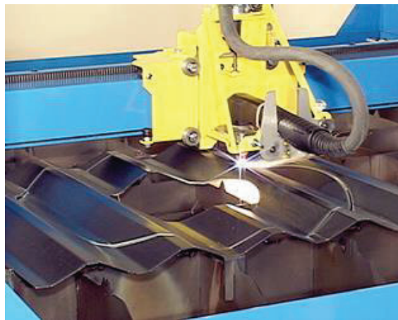
Figura 4.11. Control de altura de la antorcha de plasma trabajando (42).
