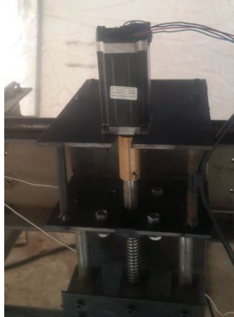
Figura 5.19. Montaje de motor en el eje Z - Z.
