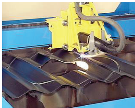
Figura 2.6. Antorcha manual adaptada al sistema de corte automático (42)
