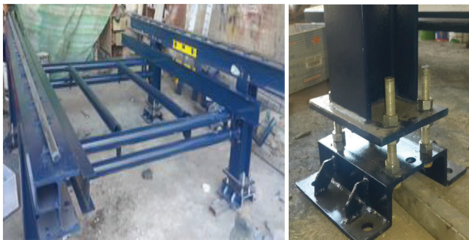
Figura 5.16. Alineación de estructura fija después de pasar el proceso de limpieza y pintado. (a) Vista general, (b) Acercamiento a la base de anclaje
