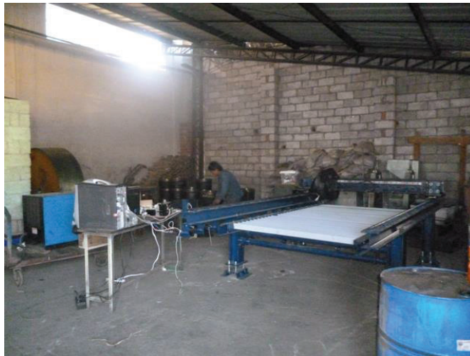
Figura A1. Pruebas de funcionamiento de los ejes de movimiento de la máquina de corte
