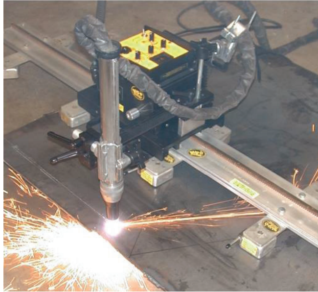
Figura 1.3. Sistema semiautomático de corte con plasma (9).
