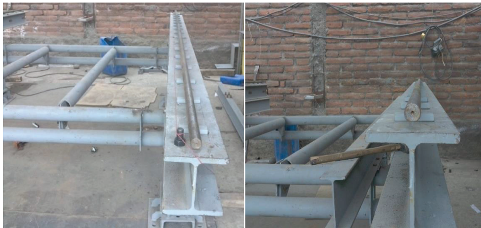
Figura 5.8. Alineación de guías eje X-X.
