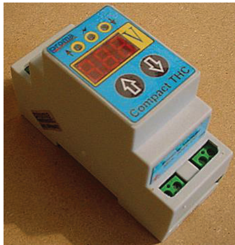
Figura 4.13. Control de altura de la antorcha THC Compacto 150 (62).
