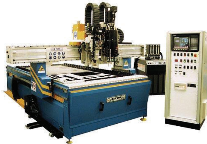
Figura 1.6. Sistema automático de corte de planchas mediante plasma (11).
