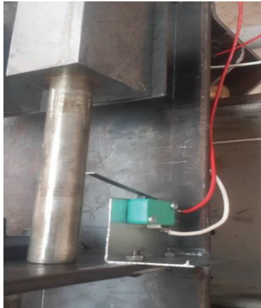
Figura 5.21. Sensor tipo palanca NC del eje Z – Z.
