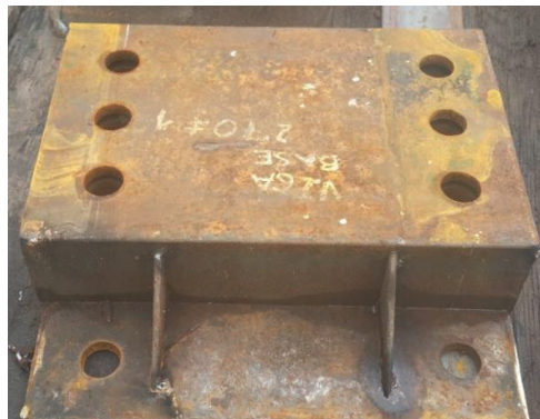
Figura 5.5. Armado de bases de nivelación de mesa.
