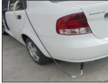
Figura 3.32 Instalación de la sonda de gases.
