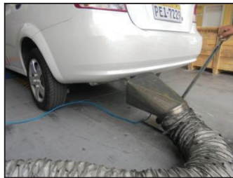
Figura 3.16 Extractor de gases en la terminación del sistema de escape.
