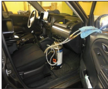
Figura 3.33 Colocación del tanque de presión de combustible.
