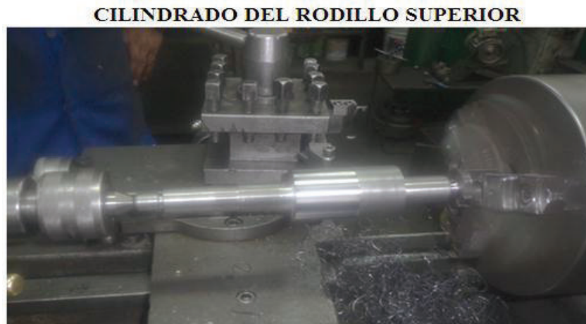
Figura N° 3.4. Cilindrado del rodillo superior. Fuente: Propia
