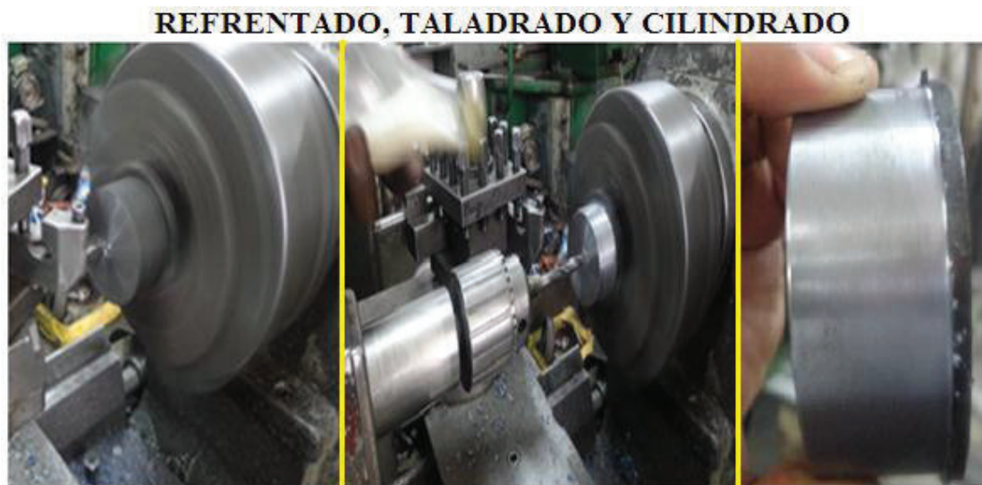
Figura N° 3.16. Refrentado, taladrado, y cilindrado. Fuente: Propia
