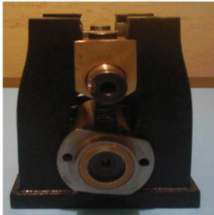
Figura N° 3.41. Sistema de cojinete superior Fuente: Propia.
