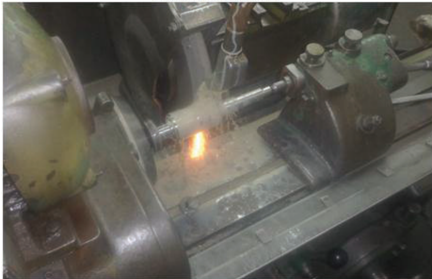
Figura N° 3.6. Rectificado del rodillo superior. Fuente: Propia
