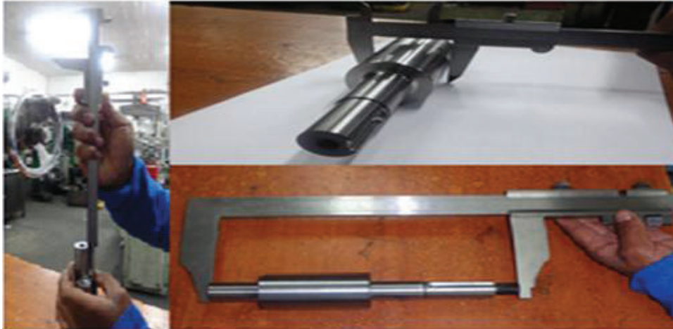
Figura n° 3.10. Mediciones del rodillo inferior Fuente: Propia
