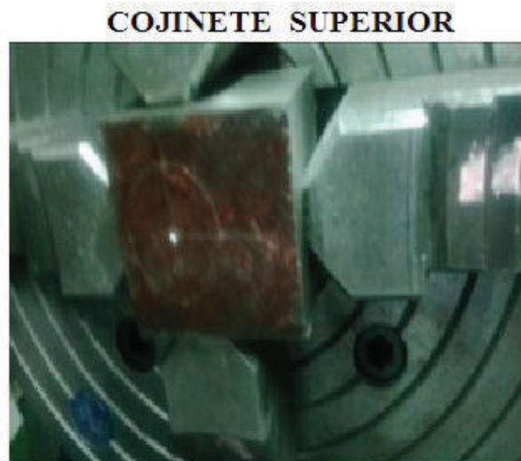
Figura N° 3.27. Construcción del Cojinete Superior. Fuente: Propia.
