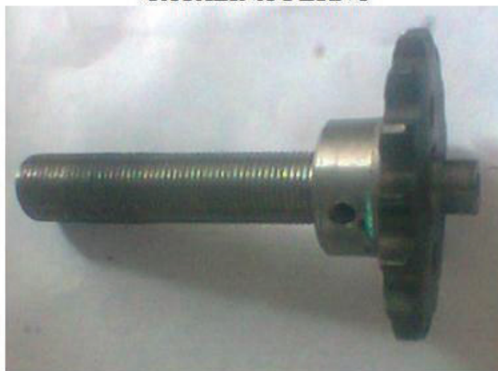
Figura N° 3.26. Catalina acoplada al perno. Fuente: Propia.
