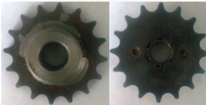
Figura N° 3.25. Catalina acoplada al eje. Fuente: Propia.
