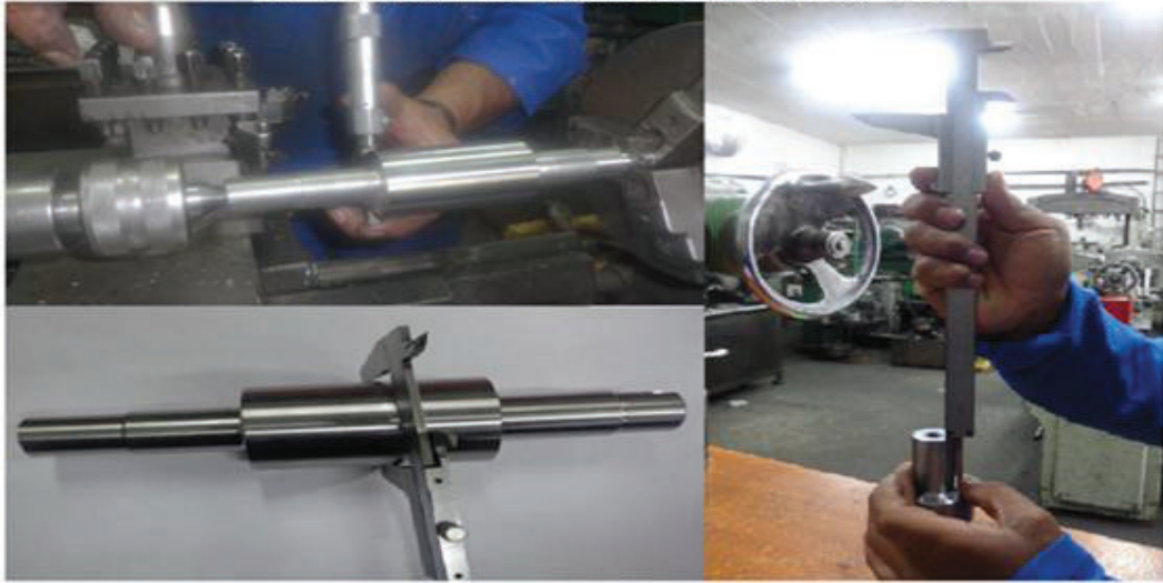
Figura N° 3.7. Mediciones del rodillo superior. Fuente: Propia
