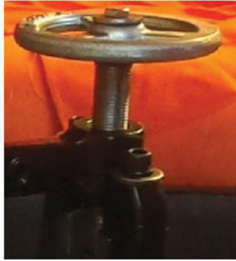
Figura N° 3.23. Acople volante –perno.. Fuente: Propia.
