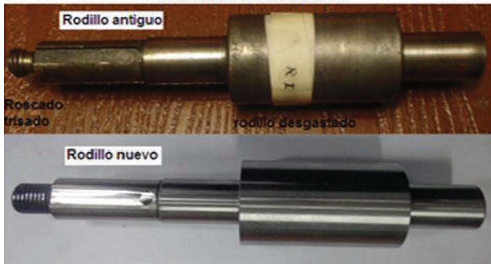
Figura N° 3.11. Proceso terminado del rodillo inferior. Fuente: Propia.
