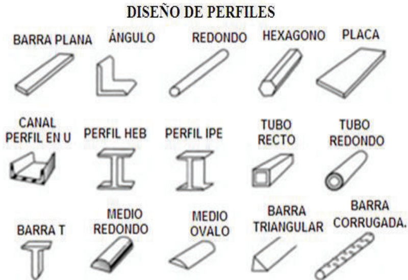
Figura. N° 1.2. Perfiles de acero.
