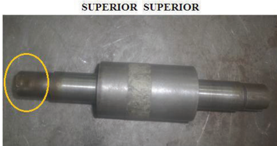
Figura N° 2.9. Fallas en los Rodillos Fuente: Propia
