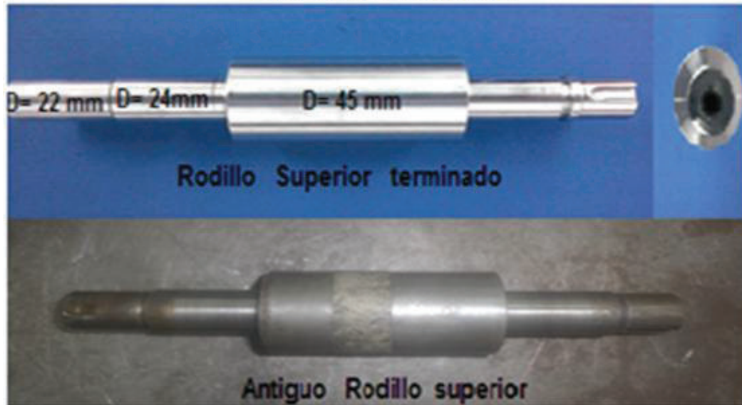
Figura N° 3.8. Proceso terminado del rodillo superior. Fuente: Propia.
