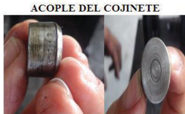
Figura N° 3.31. Acople del cojinete superior. Fuente: Propia.
