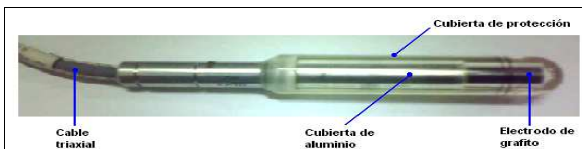
Figura 2.7: Cámara de ionización Farmer 2571 28
