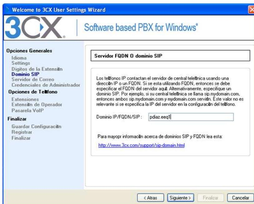
Figura 4.95 Configuración del nombre del servidor de telefonía SIP 3CX
