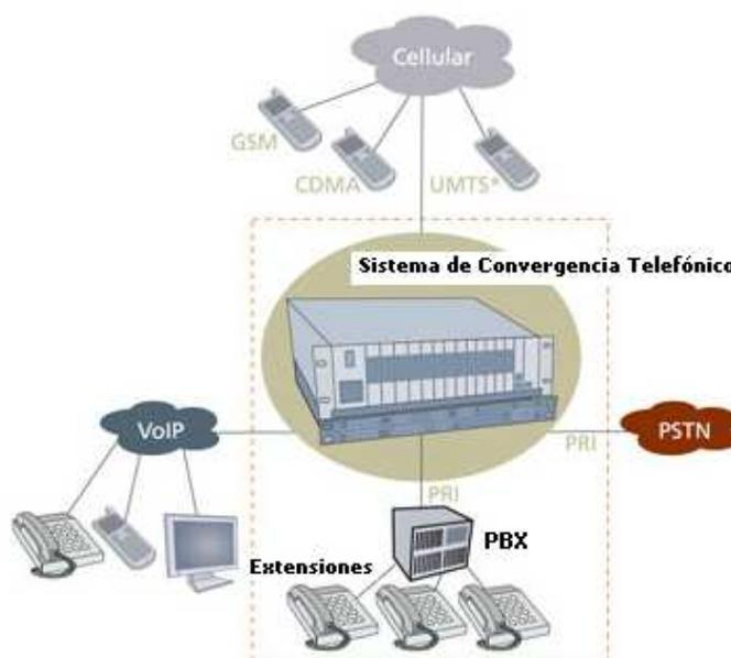
Figura 3.11 Esquema de integración de telefonía IP y analógica [17]
