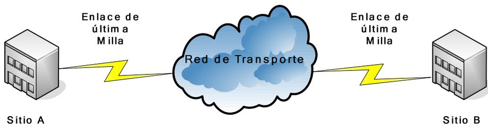
Figura 1.1 Esquema básico de un enlace dedicado
