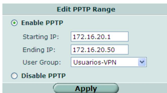
Figura 4.54 Formulario para la configuración del servidor VPN PPTP
