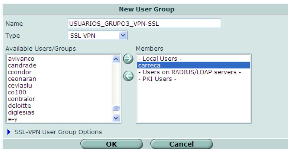
Figura 4.60 Creación de un grupo de usuarios tipo SSL VPN
