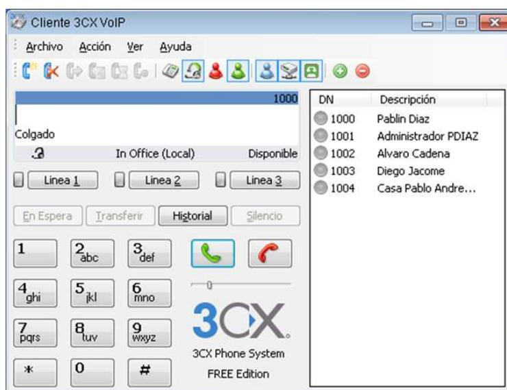
Figura 4.98 Cliente de telefonía IP SIP 3CX listo para el servicio
