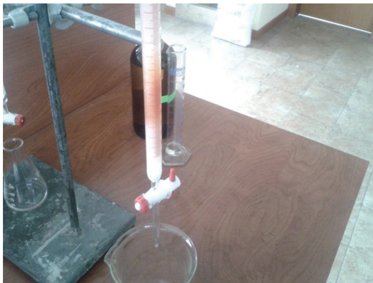
Figura AX. 1. Elución de los compuestos presentes en la resina de acuerdo a sus tiempos de retención
