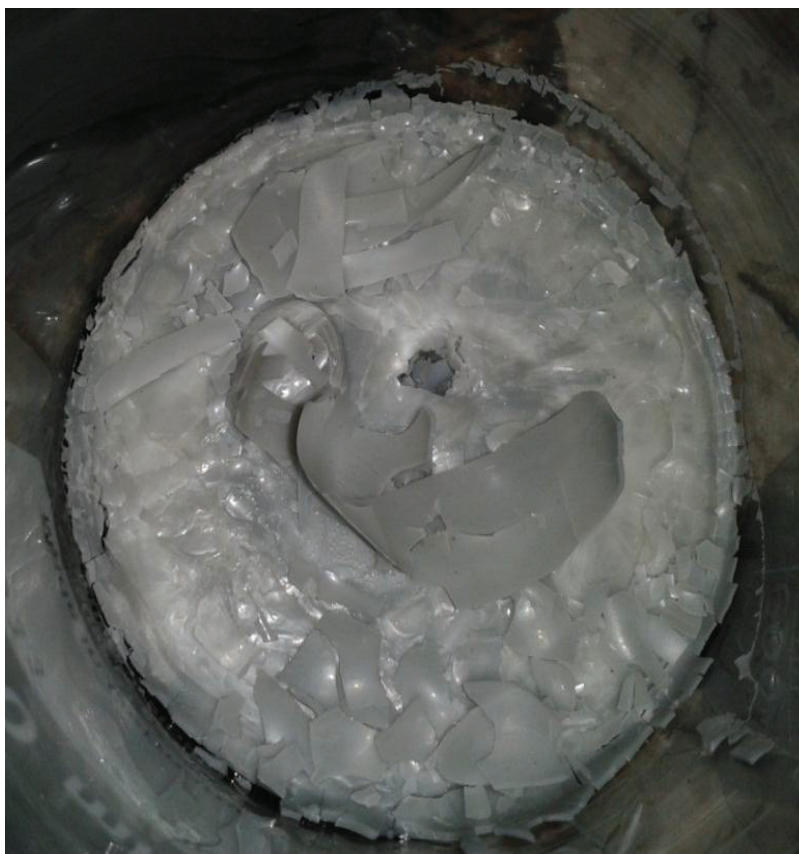
Figura 3. 4. Mezcla 40% PC y 60% fenol a las condiciones de síntesis ( T = 90\text{ }^{\circ}\text{C} )
