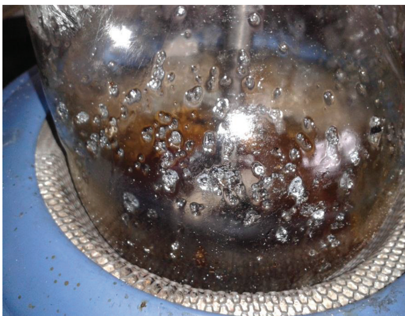
Figura 3. 3. Material sin disolver por causa de baja temperatura
