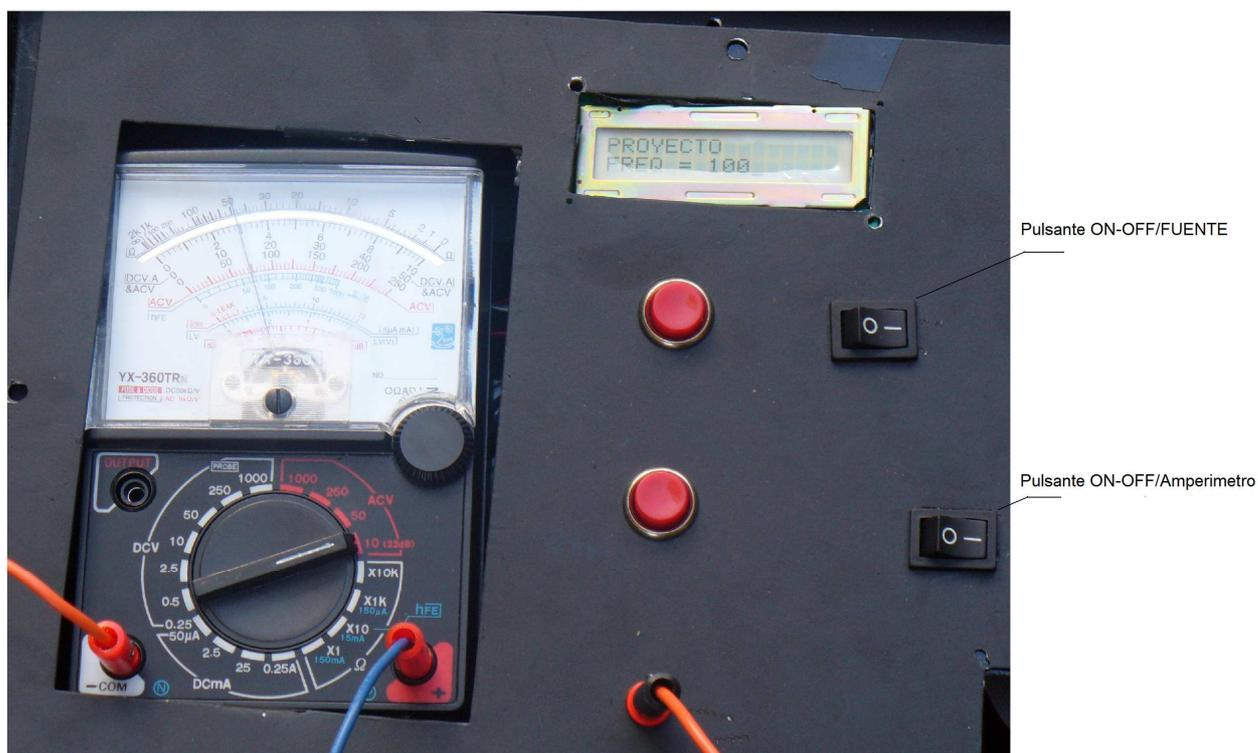
**Fig. 4.5 Instrumento para medir la resistividad del suelo**
