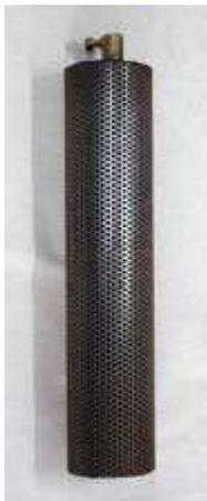
**Fig. 2.2 Electrodo de grafito rígido**
