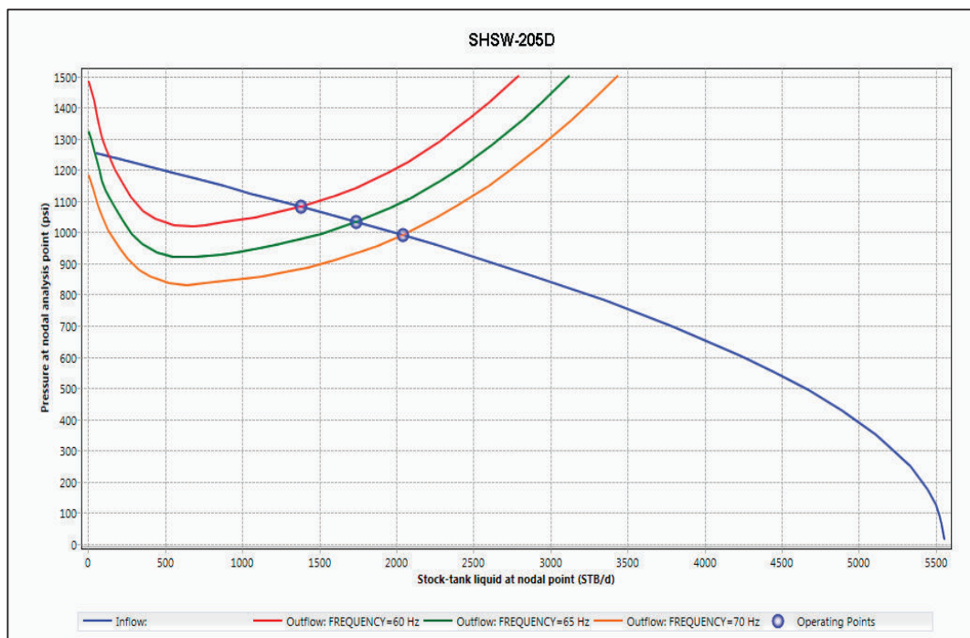
FIGURA 3.24 ANÁLISIS DEL POZO SHSW-205D CON LA BOMBA REDA GN3200
