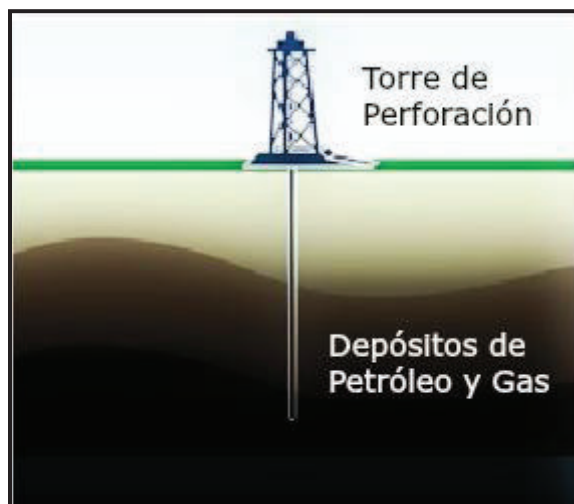
Figura 2.1: Perforación de un Pozo Vertical
