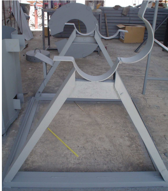
Fotografía 2. Estructura del sistema de basculación
