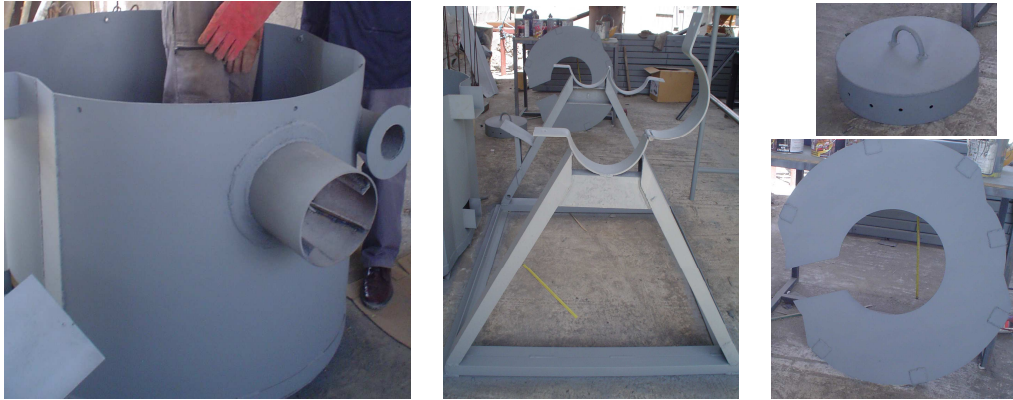
Fotografía 10. Recubrimiento con pintura antioxidante.
