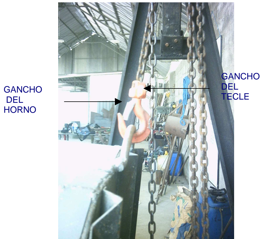
Fotografía 5. Enlace del gancho del horno al gancho del tecla
