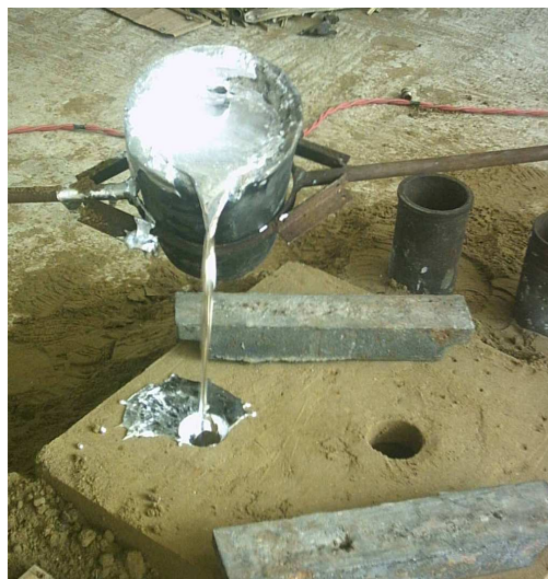
Fotografía 26. Colocación del metal en los moldes.
