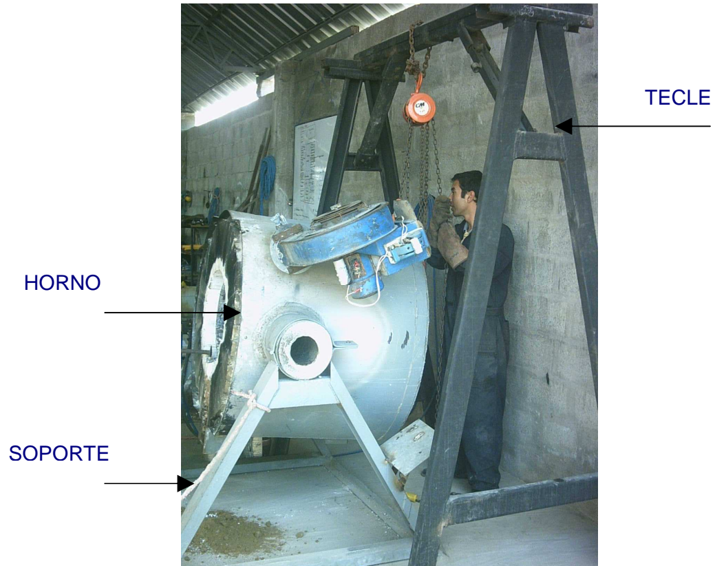
Fotografía 6. Esquema general del horno
