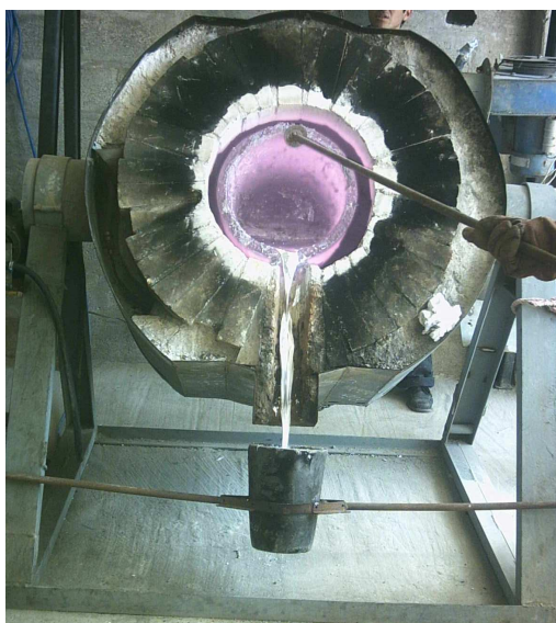
Fotografía 25. Colado del metal.
