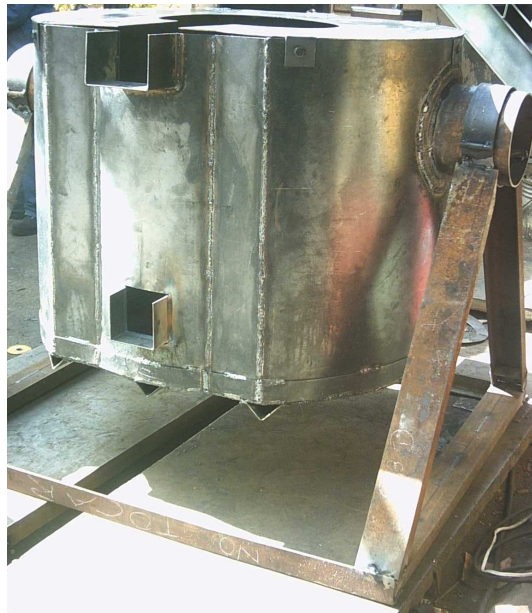
Fotografía 3. Estructura del sistema de basculación junto al horno.
