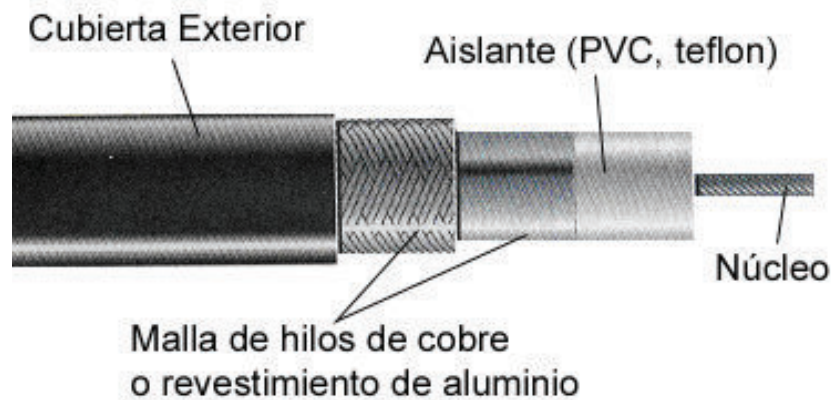
Figura 1.13 Estructura interna del cable coaxial [8]
